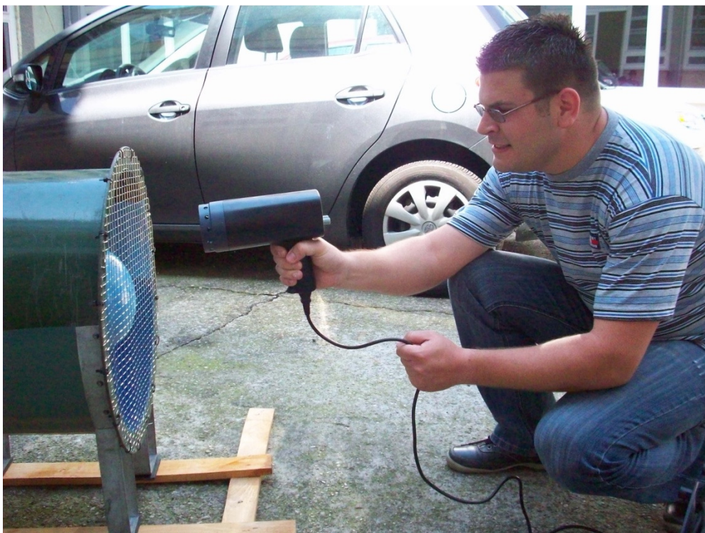
Slika 4-2 Mjerenje broja okretaja ventilatora stroboskopom
