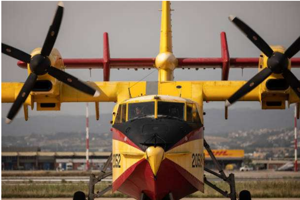
Slika 11. Prikaz vertikalnih dijelova na horizontalnom stabilizatoru [5]
