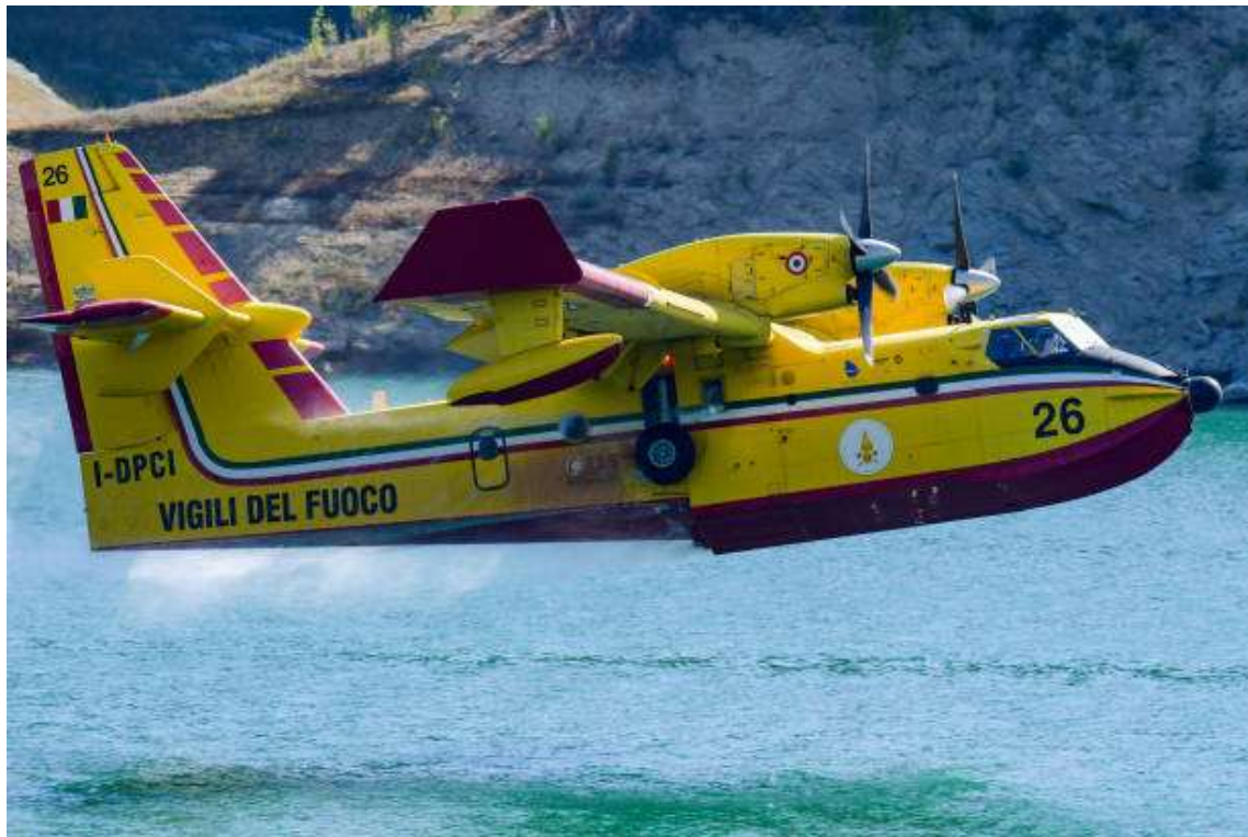
Slika 13. Prikaz uvučenog stajnog trapa Canadair CL 415 [5]
