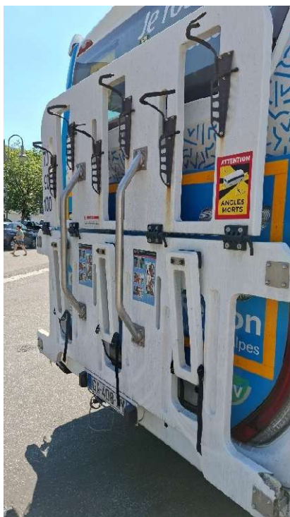
Slika 4. Nosač od sendvič konstrukcije
