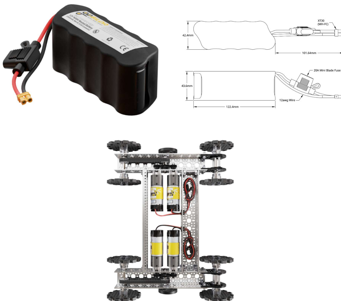
Slika 30. Prikaz, dimenzije i predviđen prostor za ugradnju baterije [12]
