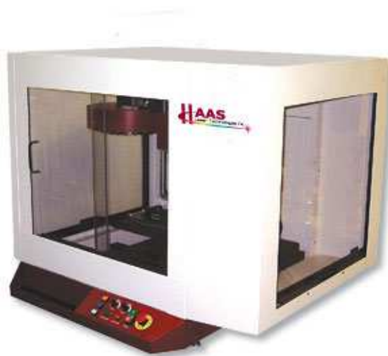
Slika 2.5. Četvero-osna stanica za lasersko mikrooblikovanje tvrtke HAAS. [13]
