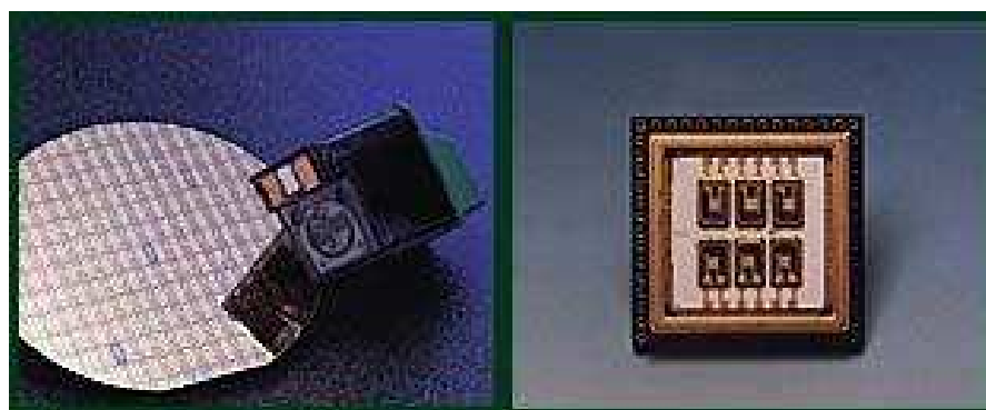
Slika 4.10. Primjeri MEMS-a: lijevo je prikazana glava za toplinsko inkjet printanje; desno je prikazan senzor mirisa. [11]
