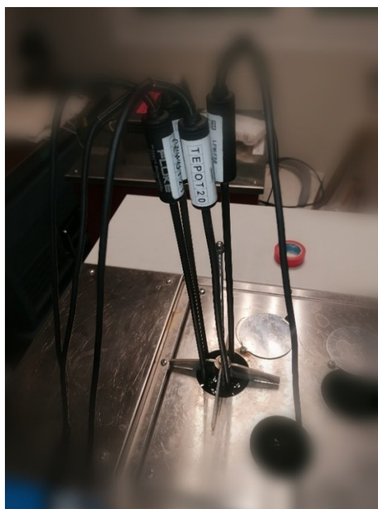
Slika 6. Platinski otpornički termometri uronjeni u kupku Kambič, interne oznake TEKUP13
