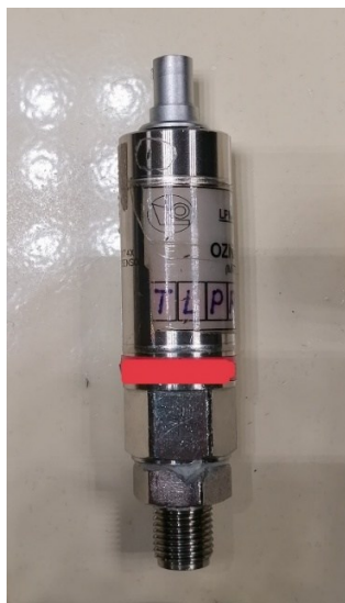
Slika 2. Pretvornik tlaka proizvođača Druck, interne oznake TLPRE05
