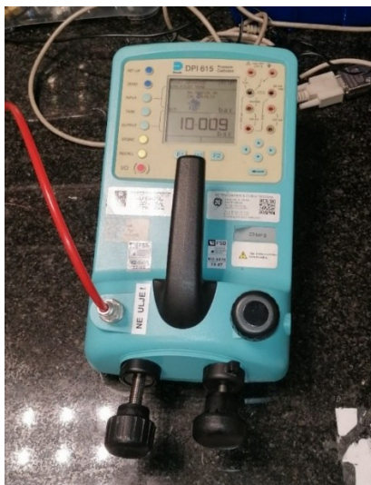
Slika 3. Kalibrator tlaka proizvođača Druck, tip DPI 615
