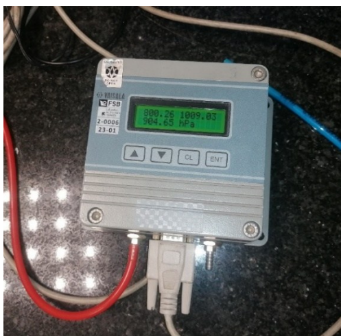
Slika 4. Pretvornik tlaka proizvođača Vaisala, tip PTB 220
