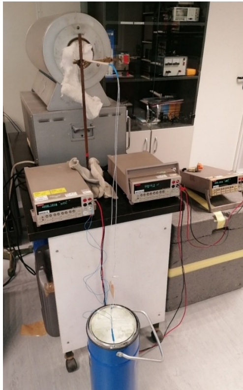
Slika 5. Termometrijska peć s Keithley multimetrima i Pt/Pd termoparom
