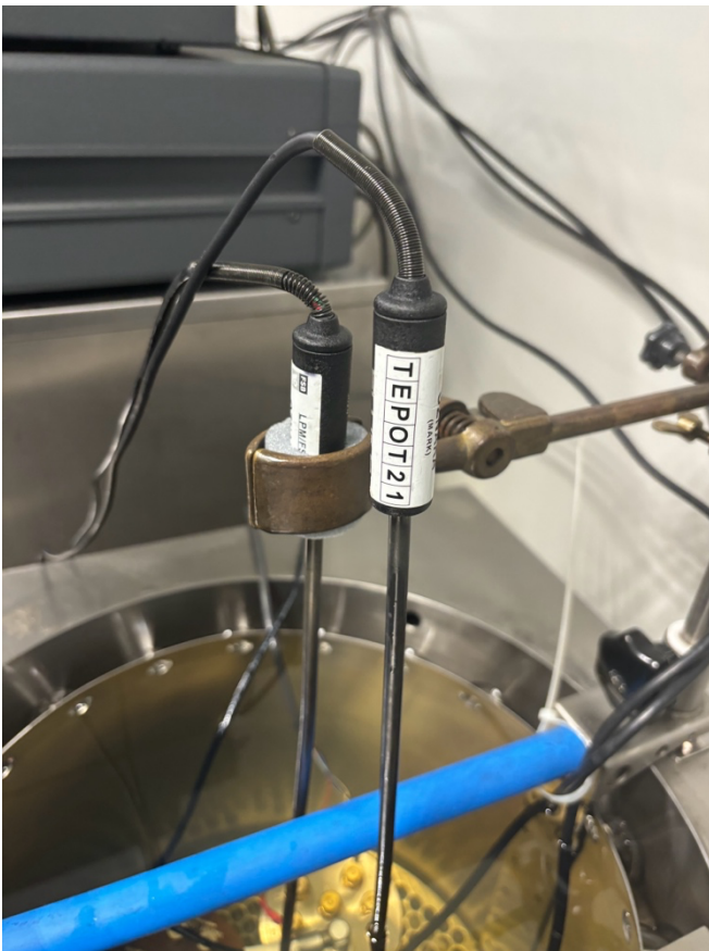
Slika 12. Otpornički osjetnici temperature
