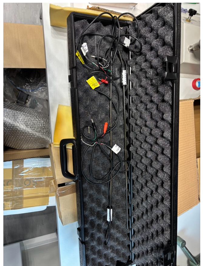
Slika 12. Otpornički osjetnici temperature
