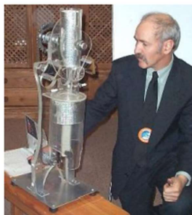
Slika 2. Beare-ov šesterotaktni motor [2]
