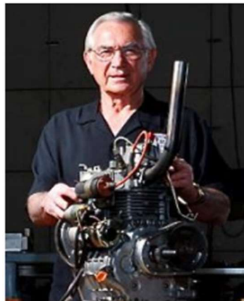
Slika 1. Crower-ov šesterotaktni motor [2]
