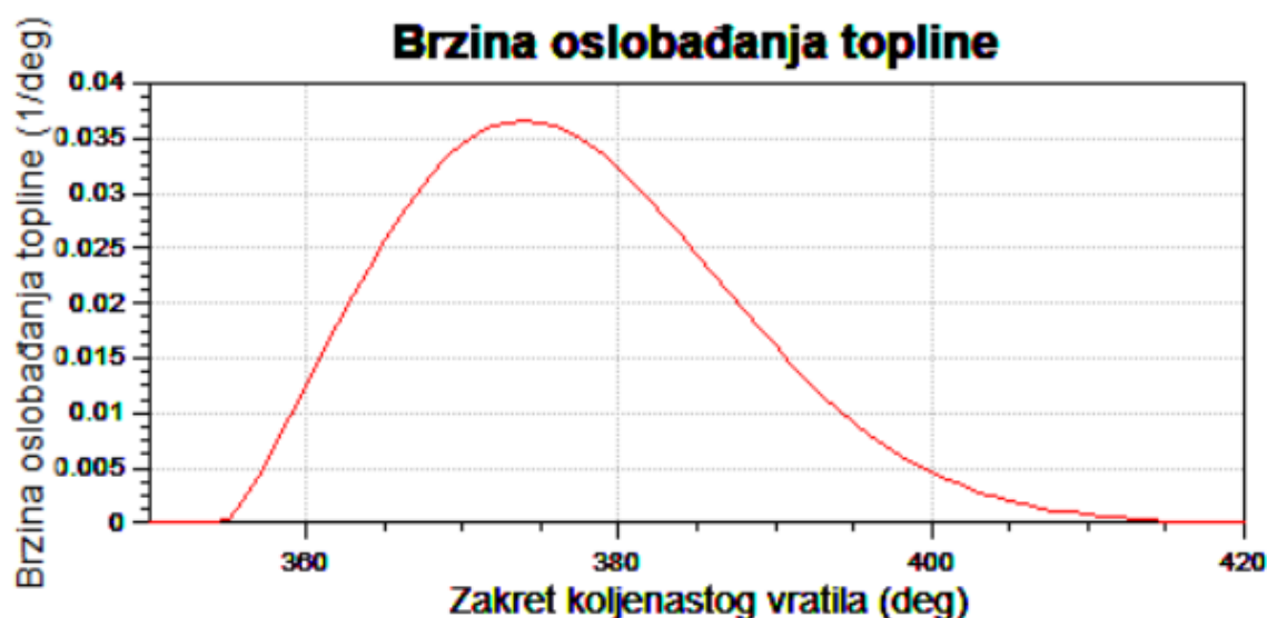
Slika 5. Brzina oslobađanja topline u cilindru – simulacija
