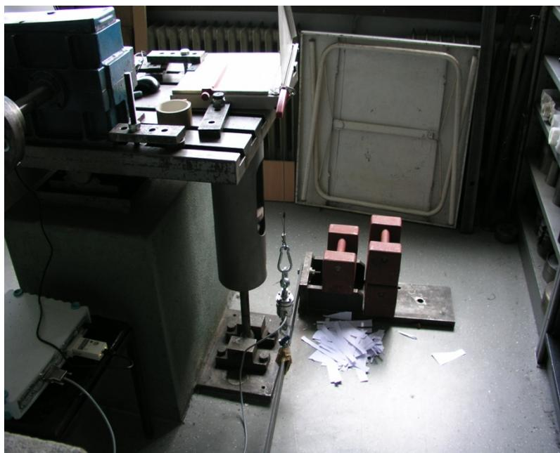
**Slika 9.** Davač sile spojen na ručicu noža i pologu te mjerno pojačalo
