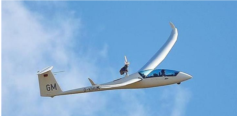
Slika 4.2. Schempp-Hirth Ventus 2cT - pogon s motorom s unutarnjim izgaranjem [16]
