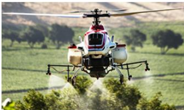
Slika 4. Letjelica s jednim glavnim rotorom prilikom prskanja [15]
