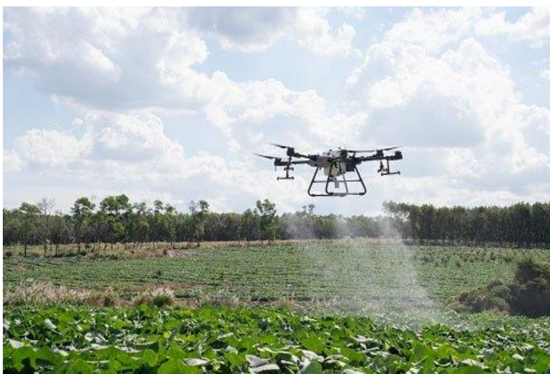
Slika 2. Multi-rotor dron pri prskanju[12]
