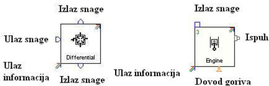
Slika 3.13.-Primjere veza na komponentama
