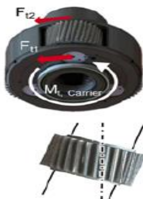
Slika 22. Zakret planeta uslijed deformacije stijenke nosača[7]
