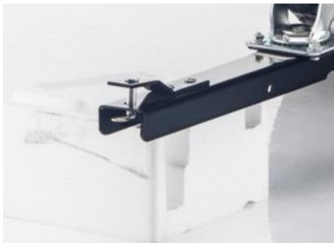
Slika 14. Prihvat prikolice na traktorsku kosilicu [4]
