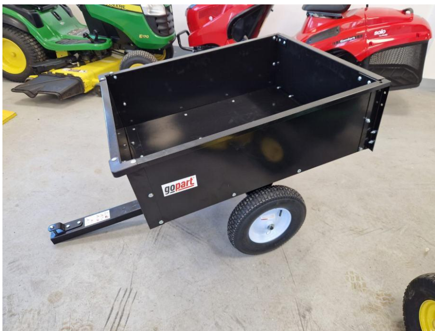
Slika 4. Klasična(vijčana) izvedba teretnog sanduka
