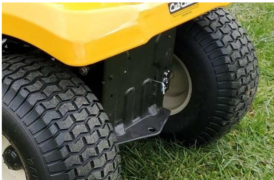
Slika 17. Prihvat za prikolicu na traktorskoj kosilici
