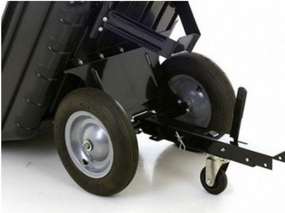
Slika 8. Podvozje od savijenih limova [4]
