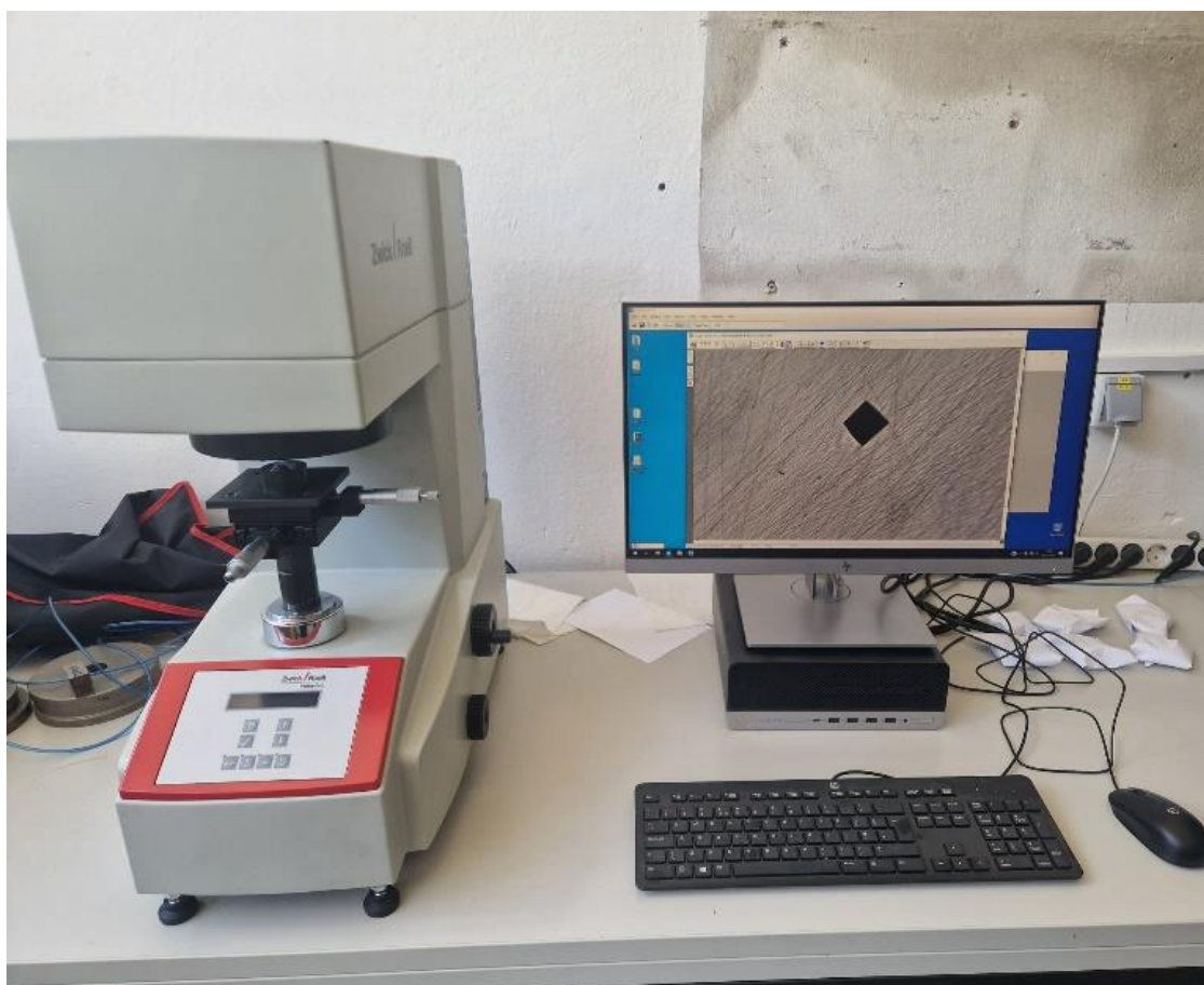
Slika 26. Oprema za mjerenje mikrotvrdoće HV0,2
