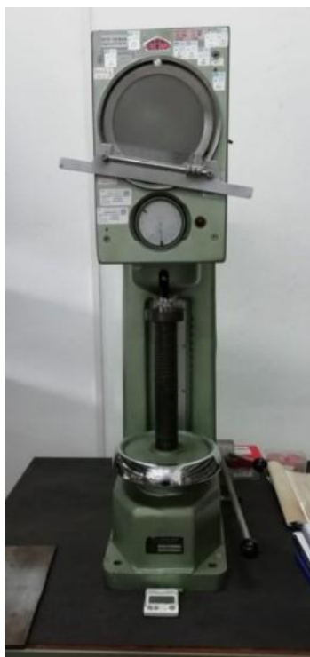
Slika 24. Uređaj za ispitivanje makrotvrdoće HV10
