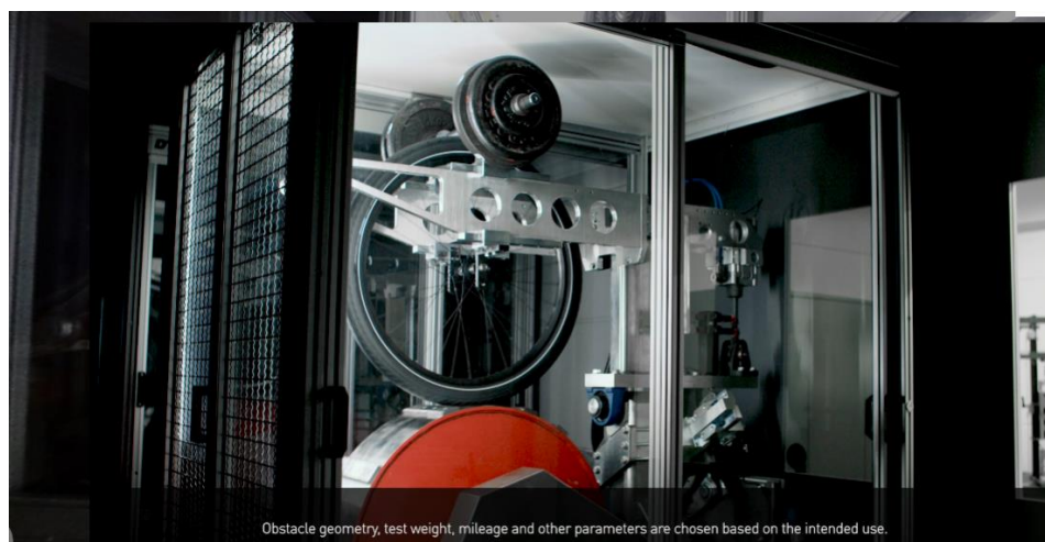
Slika 20 DT Swiss uređaj za ispitivanje zamorne čvrstoće
