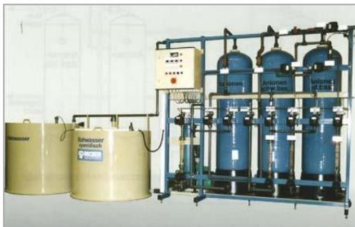
Slika 29. Lewatit kolona za ionsku izmjenu [10]
