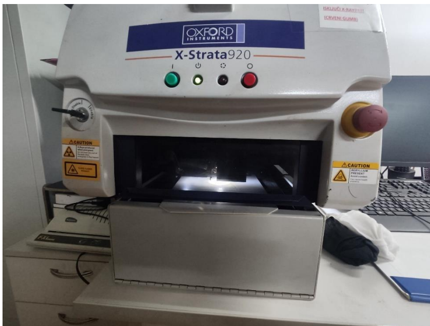
Slika 24. X-ray uređaj za mjerenje debljine prevlake
