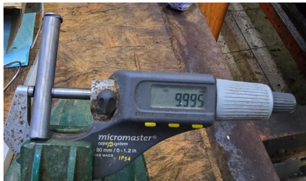
Slika 17. Mjerenje debljine etalona [14]
