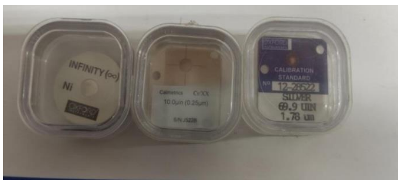
Slika 26. Etaloni korišteni za kalibraciju [9]
