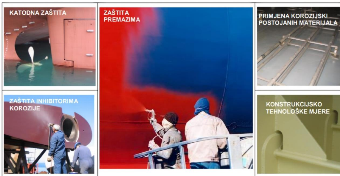
Slika 2. Prikaz metoda zaštite od korozije [3]
