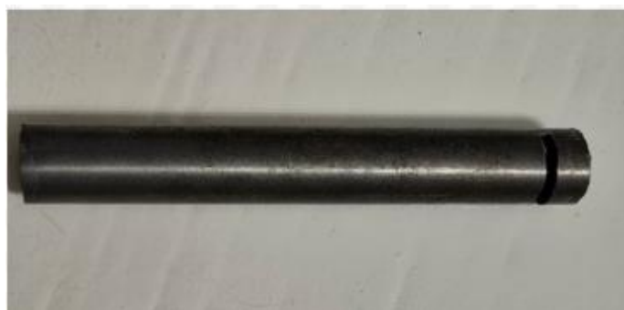
Slika 16. Izgled etalona prije kemijskog niklanja [14]
