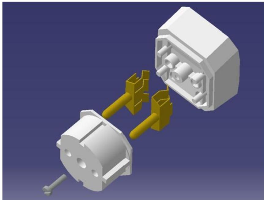
Slika 25. CAD prikaz rasklopljenog djelitelja električne energije
