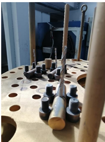
Slika 17: Postavljanje svrdla na katodi PACVD peći
