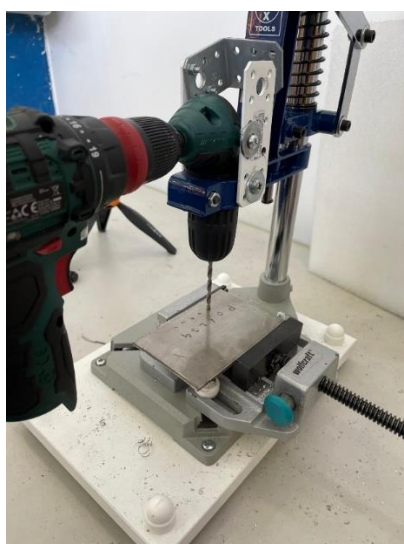
Slika 16: Postava uređaja za ispitivanje trošenja svrdla
