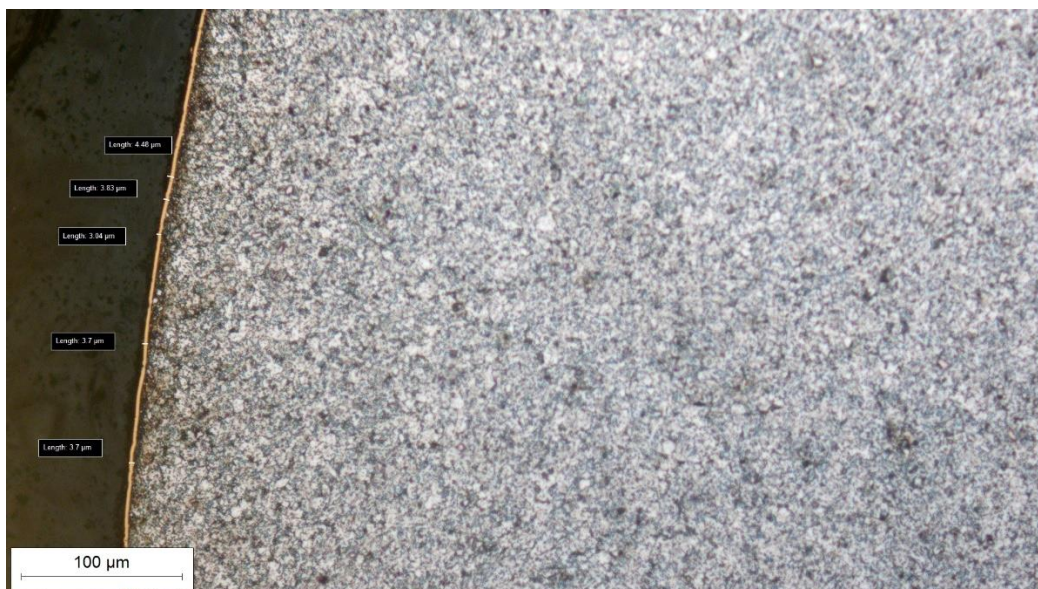
Slika 22: Debljina prevlake TiN/TiBN prevučene PACVD postupkom
