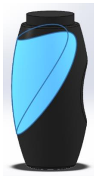
Slika 468. Površina koja se briše naredbom Delete face
