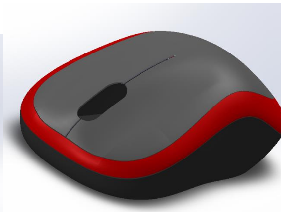
Slika 612. Gotov otvor za klikove
