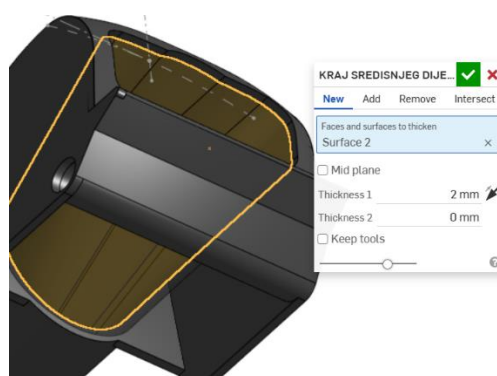
Slika 1047. Stvaranje krutog tijela iz prethodne površine
