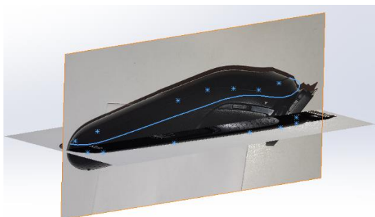
Slika 757. Prostorna rubna krivulja površine
