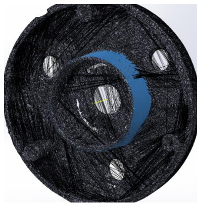
Slika 868. Stvaranje referentne osi u središtu predmeta
