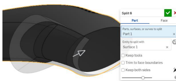
Slika 254. Rezna površina u Onshapeu
