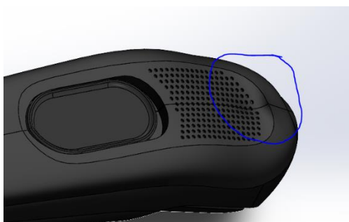
Slika 794. grub prijelaz s gornje plohe na gornju površinu
