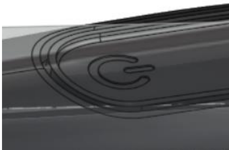
Slika 1170. Izrada simbola na gumbu
