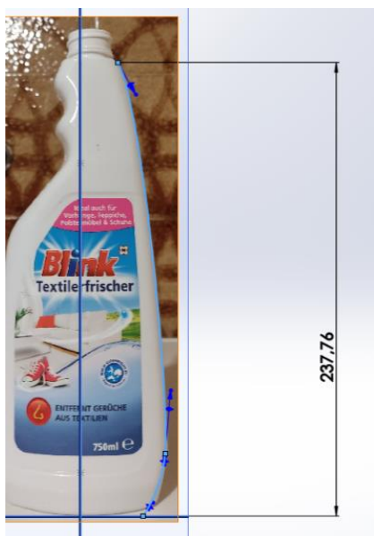
Slika 139. Izrada ruba u prednjoj ravnini
