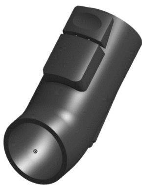
Slika 989. Izometrija cijevnog nastavka Slika 990. Druga izometrija cijevnog nastavka Izrada cijevnog nastavka započinje kreiranjem skica. Jednom skicom se skicira kružni profil, a drugom se skicira putanja po kojoj će nastati cijev.
