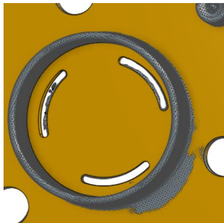
Slika 1226. Odrezivanje utora sa prednje strane
