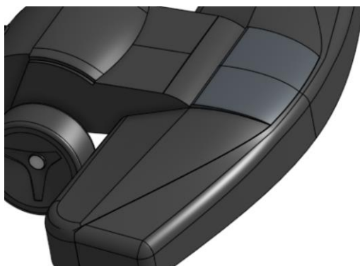
Slika 1106. Zaobljenja na vanjskim rubovima nastavka
