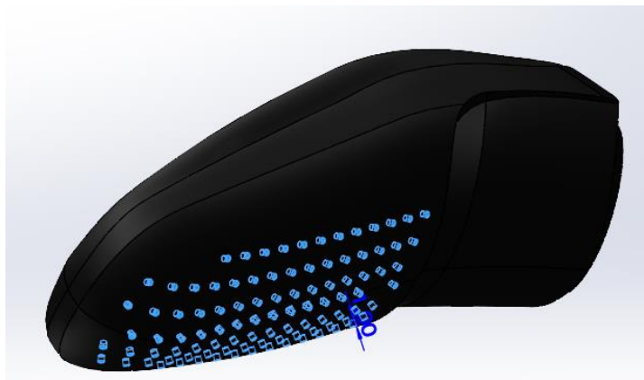
Slika 786. Izrada rupica na donjoj površini
