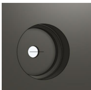
Slika 214. Izrada udubljenja i rupa s donje strane modela
