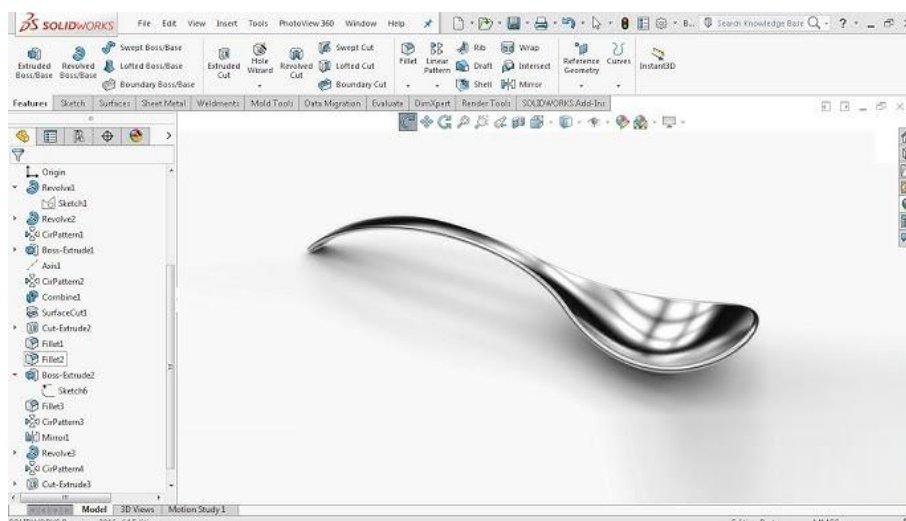
Slika 6. Model izrađen pomoću površina [9]
