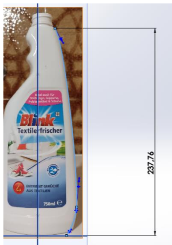
Slika 807. Izrada ruba u prednjoj ravnini
