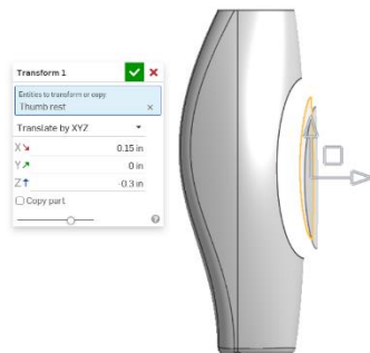
Slika 423. Pomicanje plohe u smjeru koordinata
