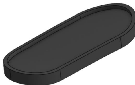
Slika 248. Udubljenje gornje površine - Onshape
