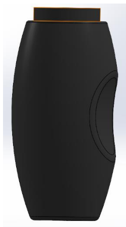
Slika 463. Zaobljenje ruba odreza
