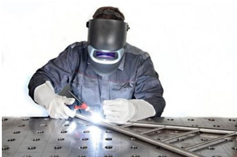
Slika 5. Desna tehnika rada pri zavarivanju [2].
