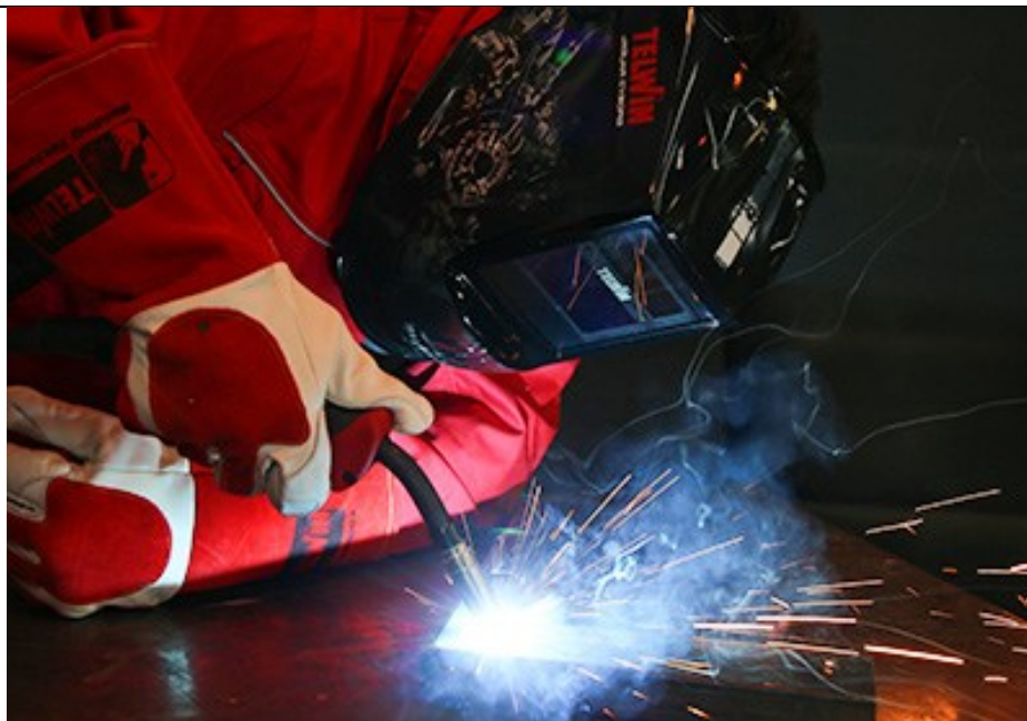
Slika 13. Postupak MIG/MAG zavarivanja u praksi [11].
