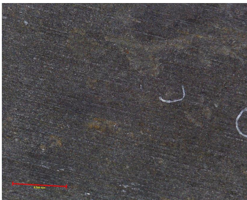
Slika 42. Korodirana površina uzorka boriranog 4 h
