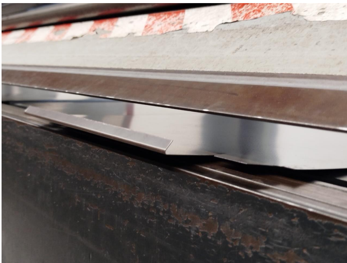
Slika 31. Pozicioniranje lima za drugi korak obrublivanja.
