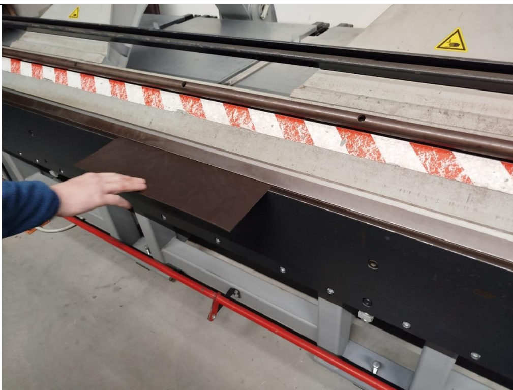
Slika 24. Zatvaranje čeljusti stroja.
