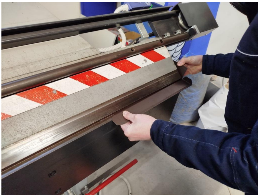
Slika 36. Ručno pozicioniranje obratka za savijanje duže stranice.
