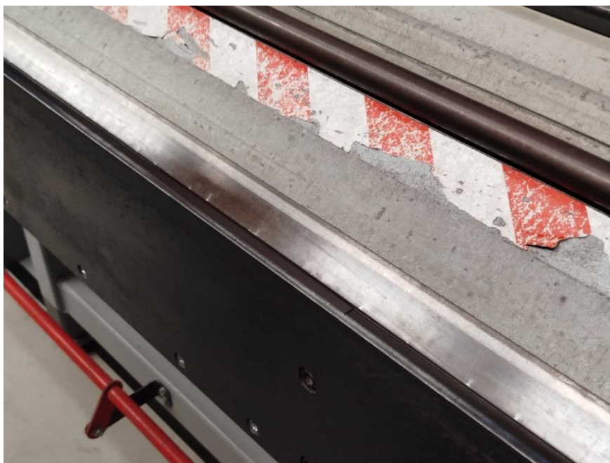
Slika 29. Pozicioniranje lima na alat savijačice.
