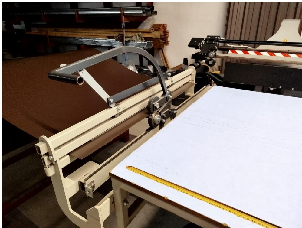
Slika 15. Škare za odrezivanje lima.
