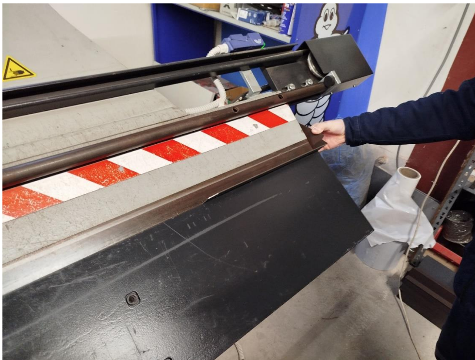
Slika 37. Savijanje dulje stranice obratka uz asistenciju radnika.
