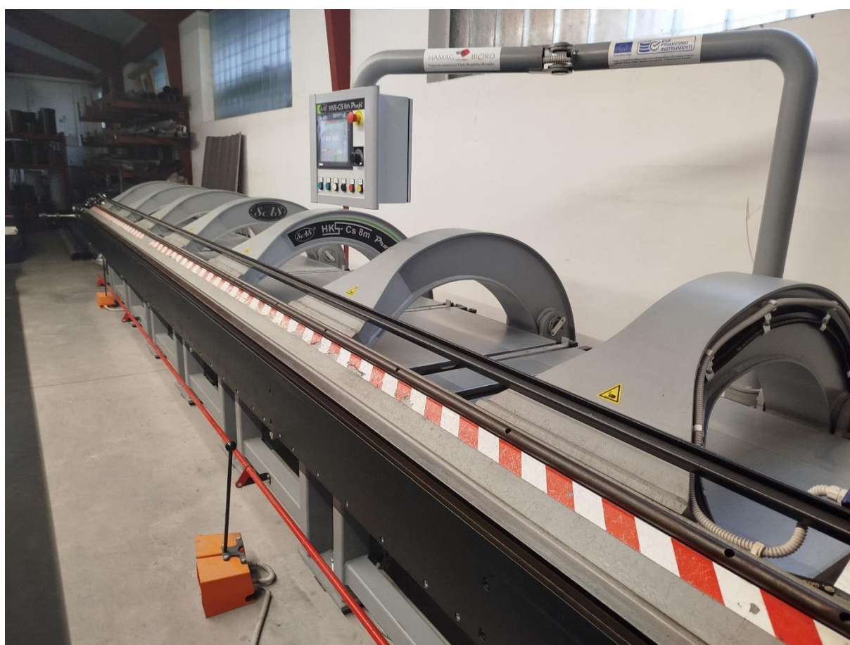
Slika 12. Stroj za rezanje i savijanje lima.
