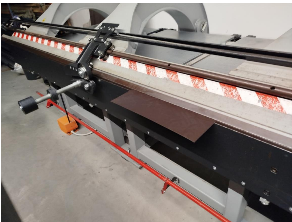
Slika 25. Škare spremne za rezanje lima.
