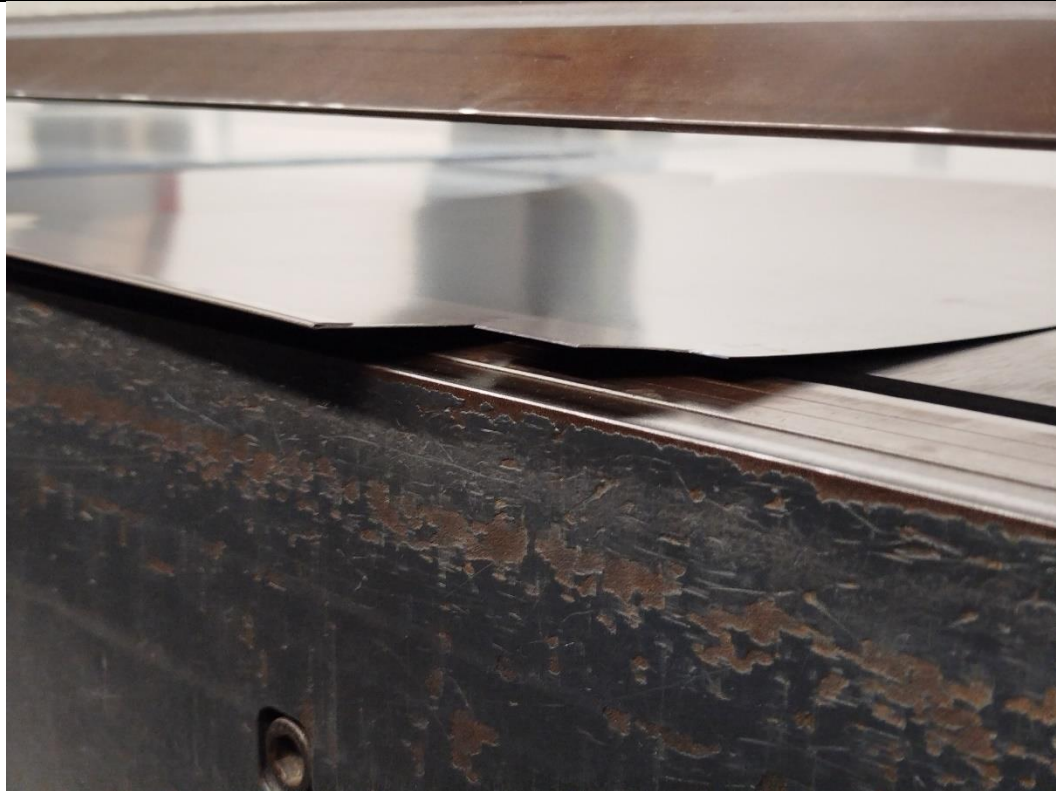
Slika 32. Lim nakon drugog koraka obrublivanja.
