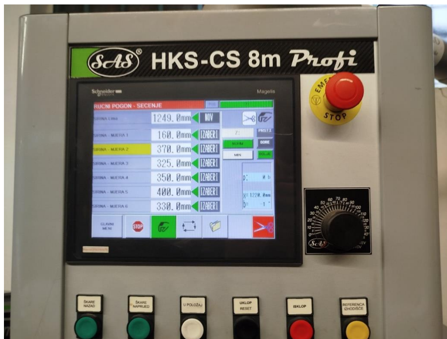
Slika 20. Podešavanje širine rezanja.
