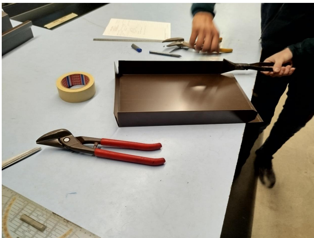
Slika 41. Ručno savijanje limenih peraca.
