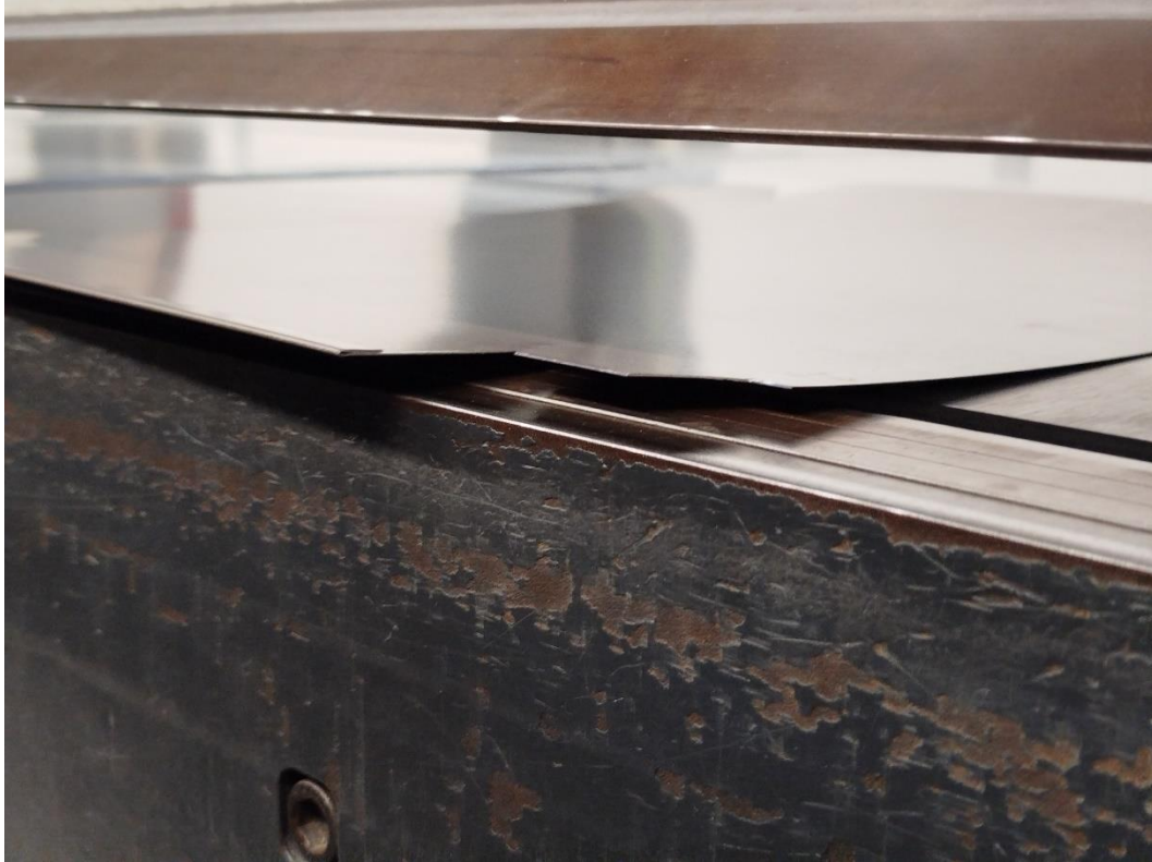
Slika 32. Lim nakon drugog koraka obrubljivanja.
