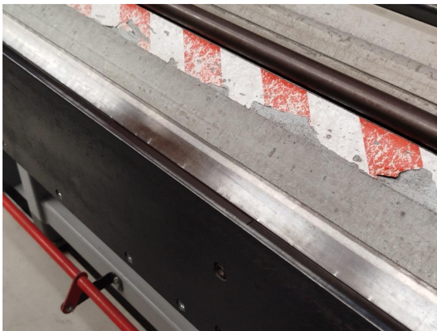
Slika 29. Pozicioniranje lima na alat savijačice.
