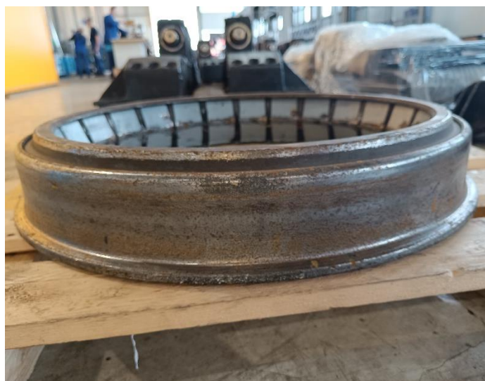
Slika 16. Obruč kotača tramvaja modela TMK 2300
