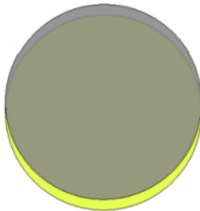
Slika 22. Nepravilnost u geometriji kotača uzrokovano obradom [19]
