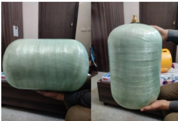
Slika 7. Kompozitna LPG tlačna posuda [9]
