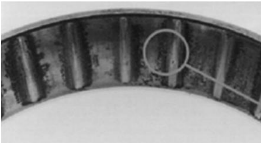
Slika 21. False brinellig kod igličastog ležaja [21]
