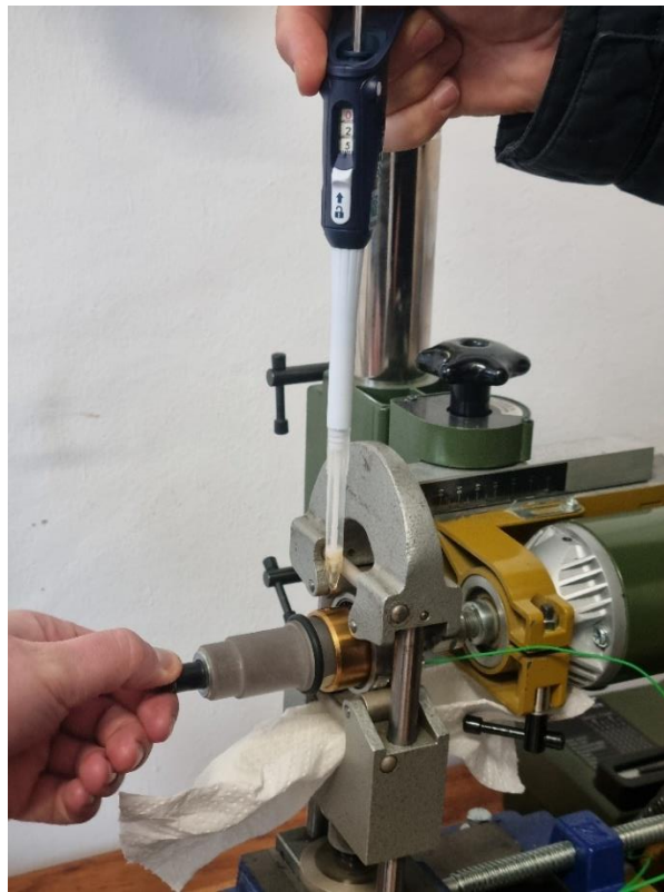
Slika 28. Postupak podmazivanja L3 ležaja
