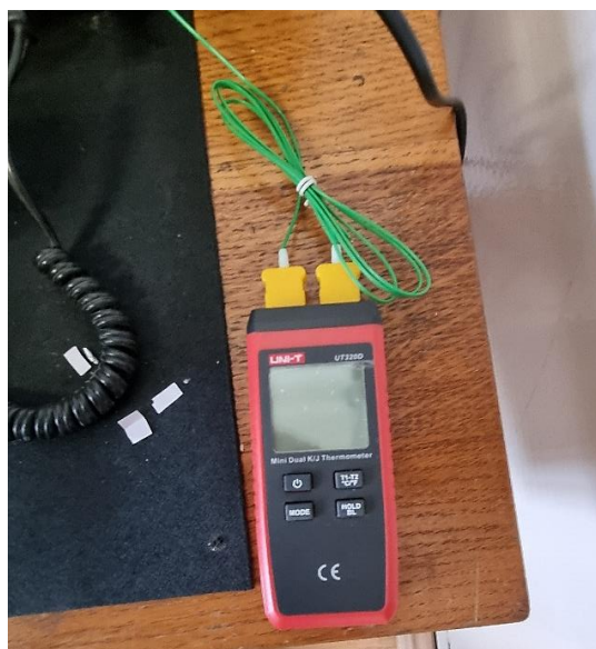
Slika 45. Uređaj UT-320D za mjerenje temperature ležaja
