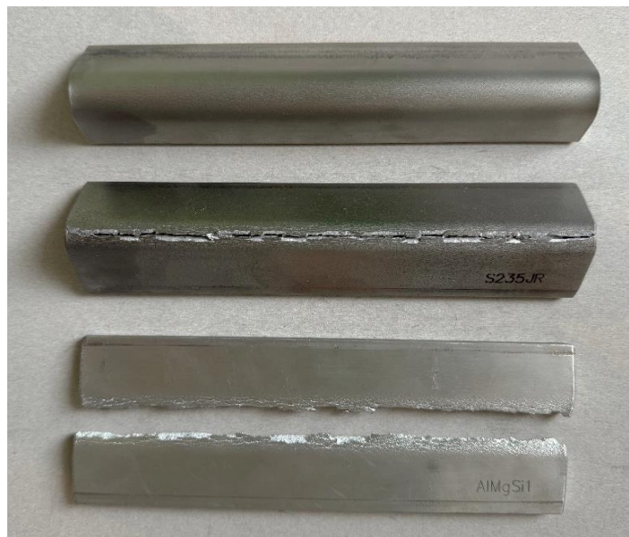
Slika 47. Pukotine na vanjskom radijusu prilikom uzdužnog savijanja
