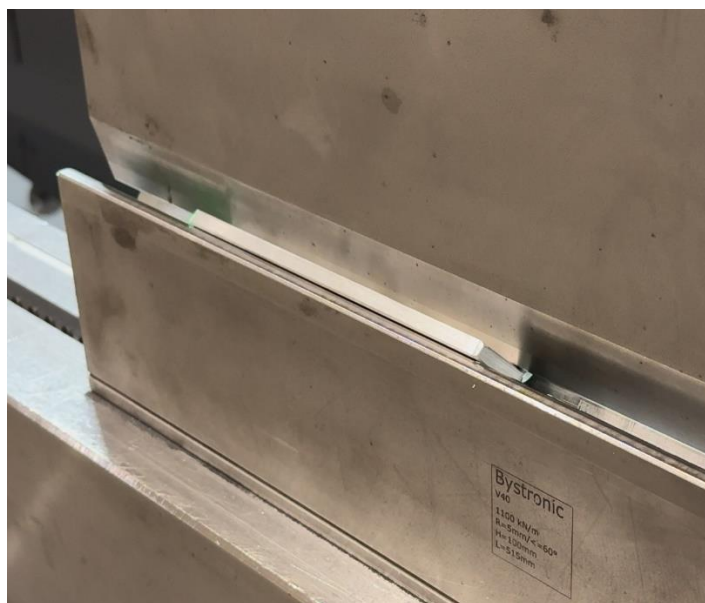
Slika 41. Uzdužno savijanje aluminija - AlMgSi1
