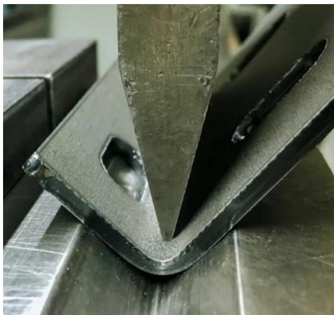
Slika 13. Oštro kutno savijanje lima velike debljine [13]
