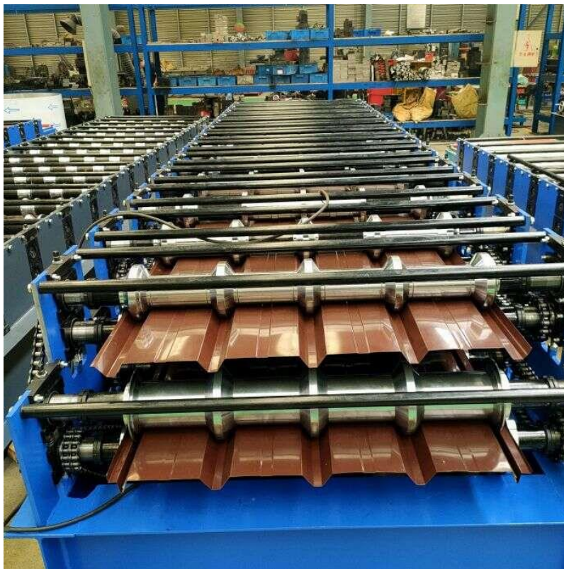
Slika 8. Profilno savijanje lima [9]
