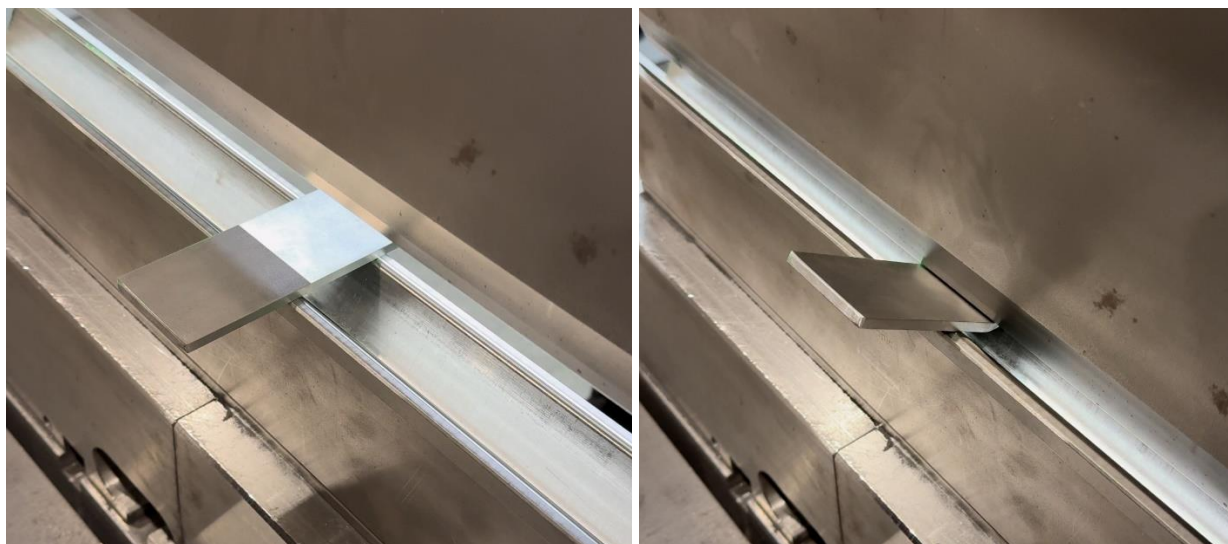
Slika 39. Savijanje S235JR na CNC savijačici
