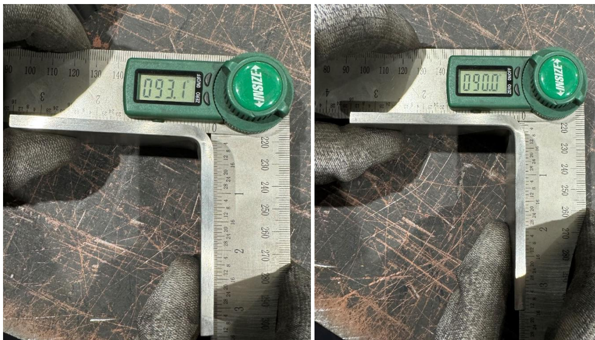
Slika 45. Mjerenje kuta savijanja bez korekcije i sa korekcijom
