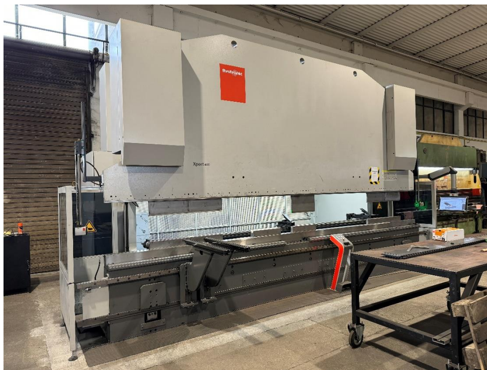
Slika 35. CNC savijačica „Bystronic Xpert 400-6200“
