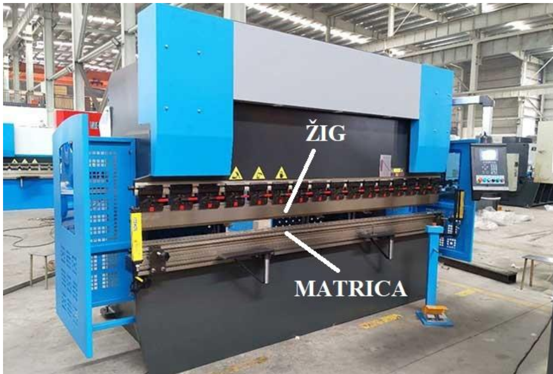
Slika 9. Savijačica za oštro kutno savijanje [10]
