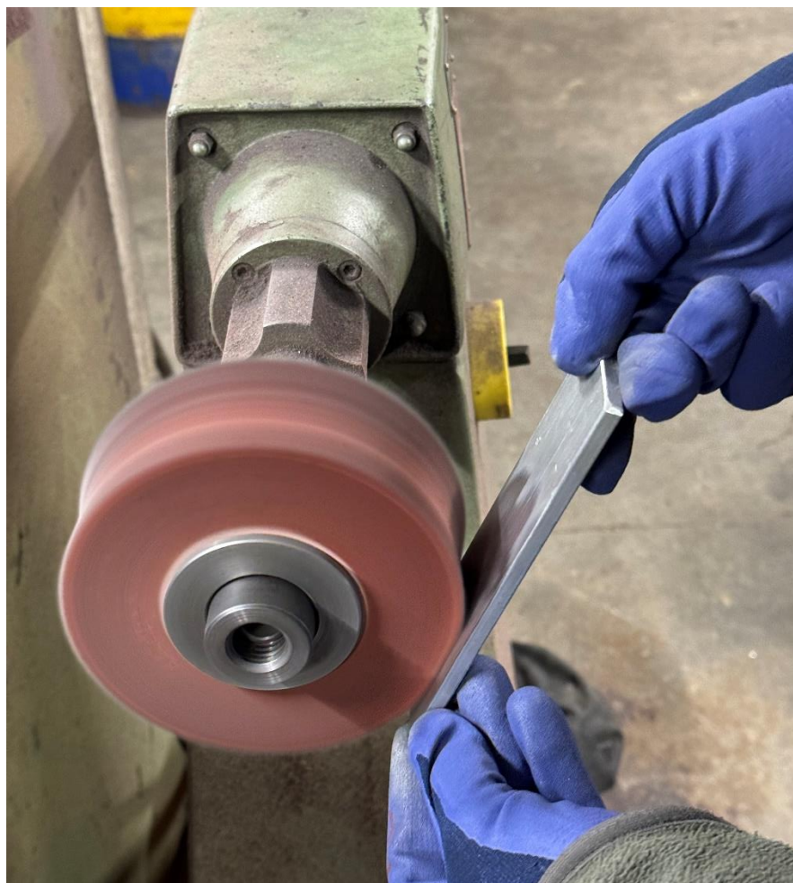
Slika 33. Poliranje početnog komada lima
