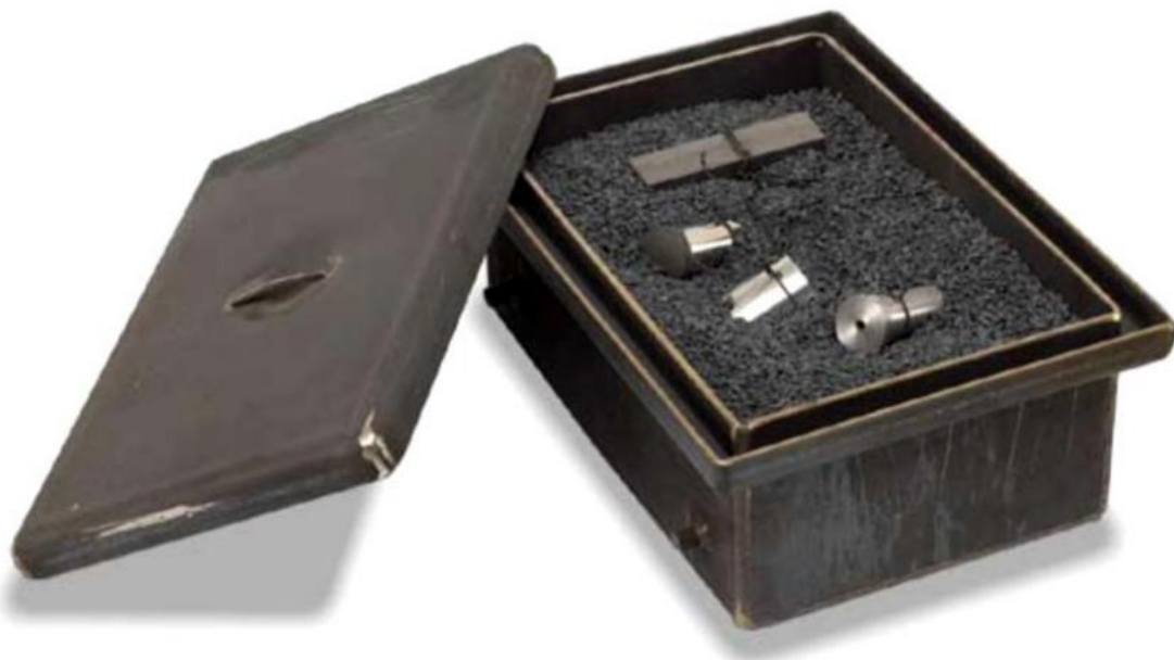
Slika 16. Kutija za boriranje s proizvodima stavljenim u granulat [34]
