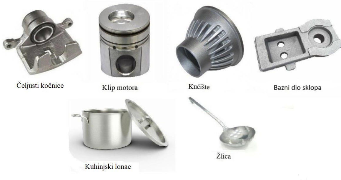
Slika 4.1 Primjeri odljevaka odlivenih gravitacijskim lijevanjem [9]
