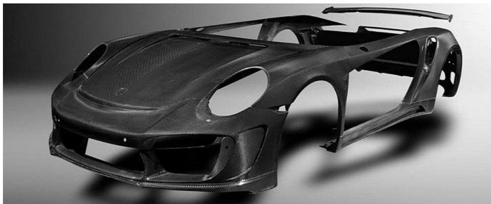
Slika 12. Paneli karoserije izrađenih od karbonskih vlakana za Porsche 911 [16.]
