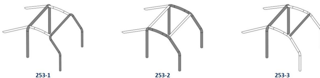
Slika 21. Dopusnjeni oblici osnovne konstrukcije zaštitnog kaveza [21.]
