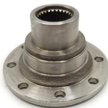
Slika 81. Prirubnica za kompenzaciju različite duljine pogonskih vratila [30.]
