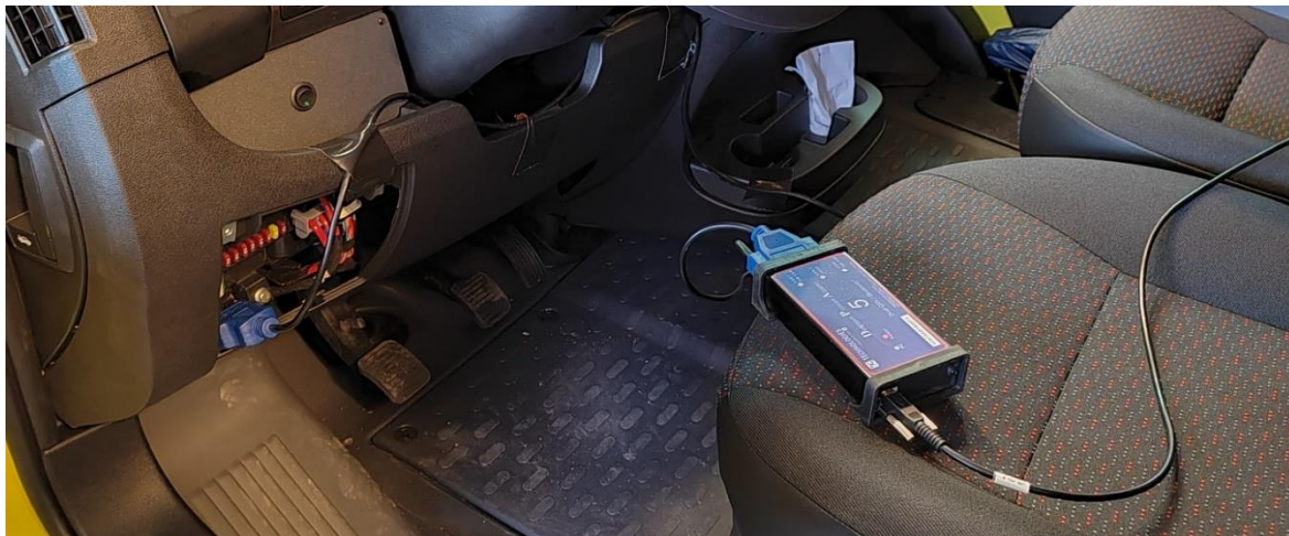
Slika 22. Uređaj za očitavanje podataka o radu motora putem OBD priključnice
