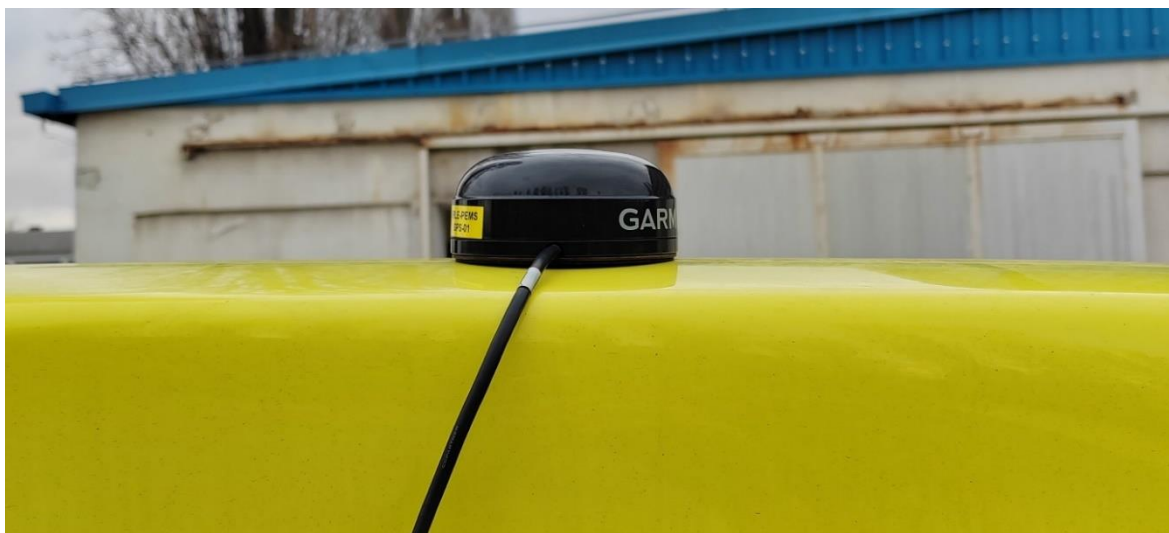
Slika 23. GPS antena postavljena na krov vozila
