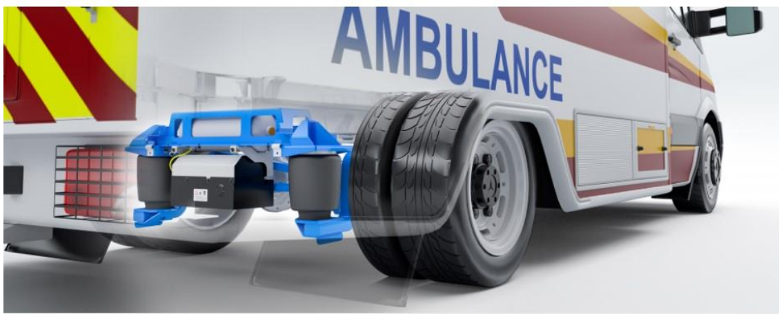
Slika 2. Ovjes tvrtke VB-Airsuspension razvijen za medicinska vozila [4]
