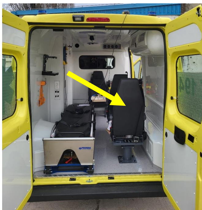
Slika 84. Sjedalo na najnepovoljnijem položaju u medicinskom vozilu
