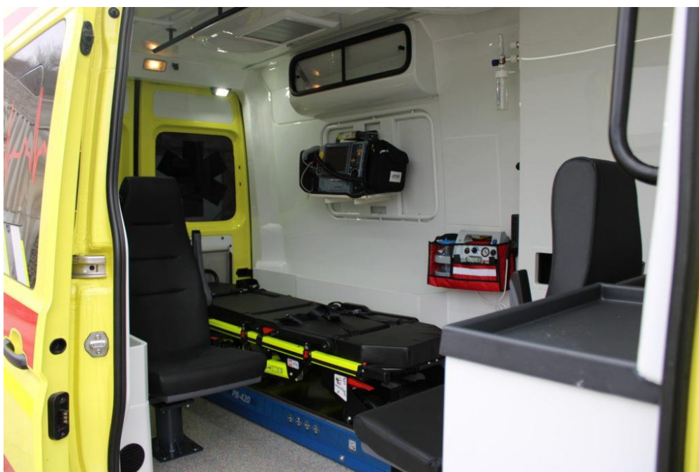
Slika 3. Interijer medicinskog vozila s opremom za pružanje hitne pomoći [5]
