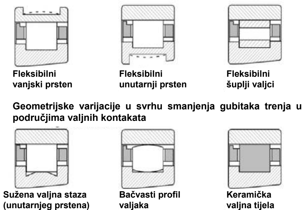
Slika 4.5. Konstruktivna rješenja ležajeva u svrhu smanjenje trenja [2]
