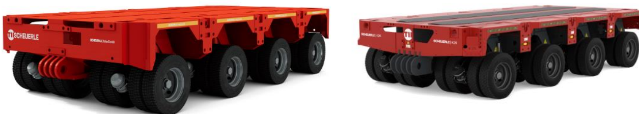
Slika 34. Scheuerle InterCombi i K25 moduli [29]
