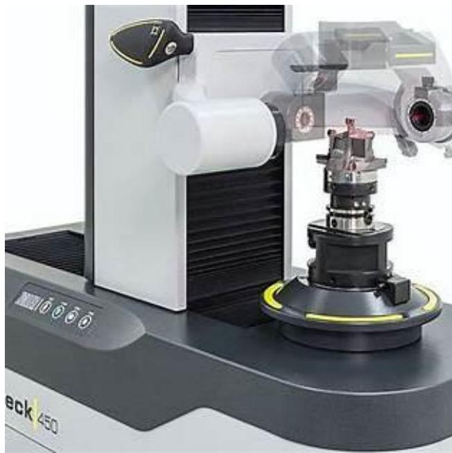
**Slika 5. - Uredaj "SmartCheck" s rotacijskom kamerom za inspekciju alata [3]**
