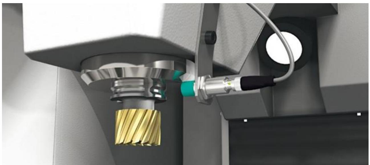
Slika 25. - RFID čitač u obradnom centru [18]
