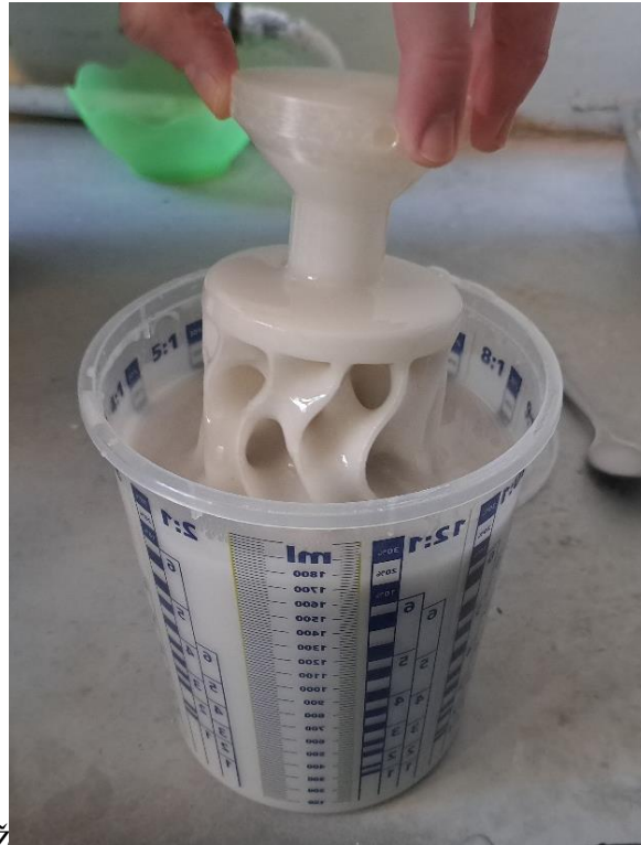
Slika 4.19. Uranjanje pramodela u keramičku suspenziju na bazi natrijevog silikata
