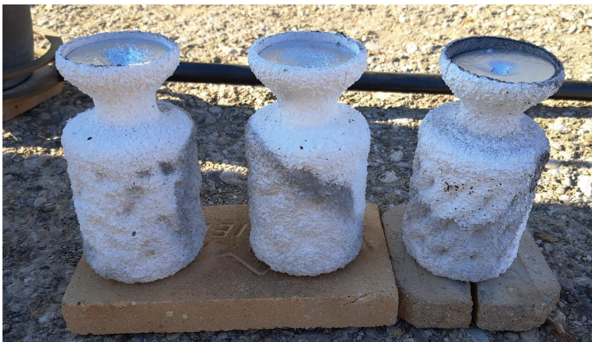
Slika 4.38. Rezultat lijevanja u keramičku školjku na bazi koloidne silike
