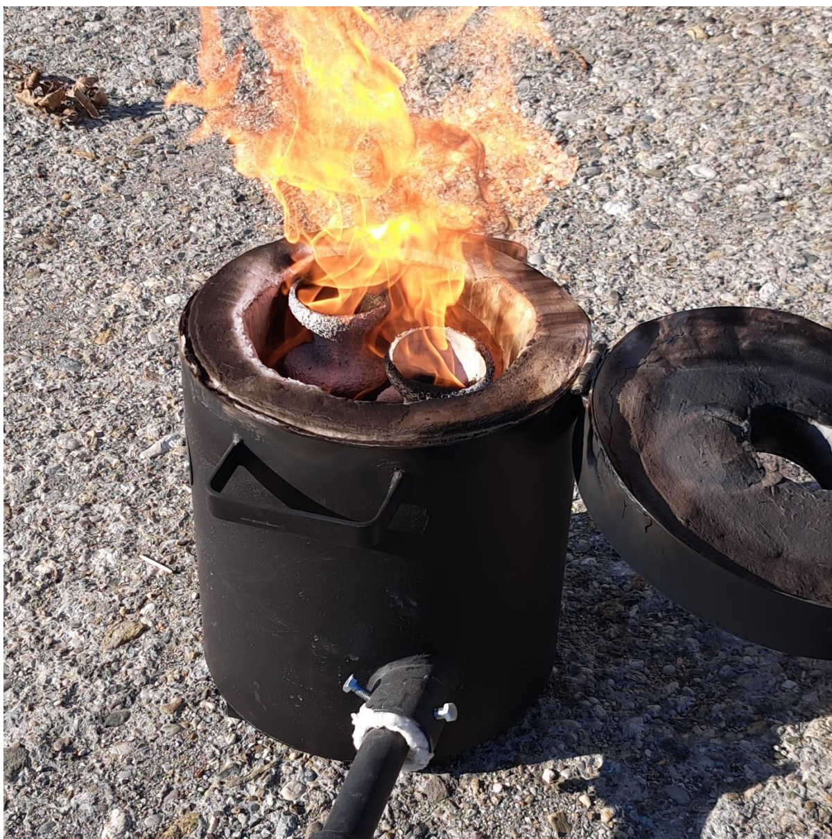
Slika 4.29. Izgaranje pramodela i žarenje keramičkih školjki
