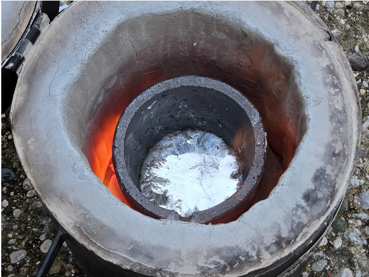
Slika 4.31. Taljenje cinkove legure ZAMAK 410 u plinskoj peći
