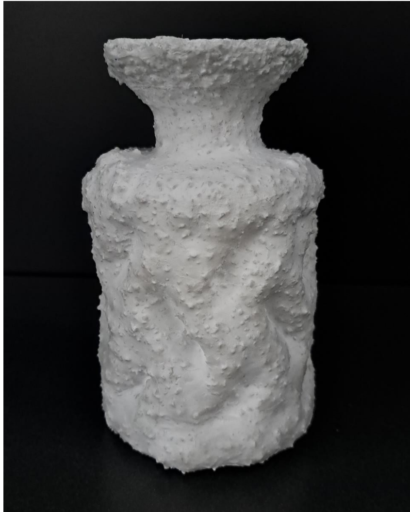
Slika 4.23. Osušena školjka proizvedena keramičkom suspenzijom na bazi natrijevog silikata
