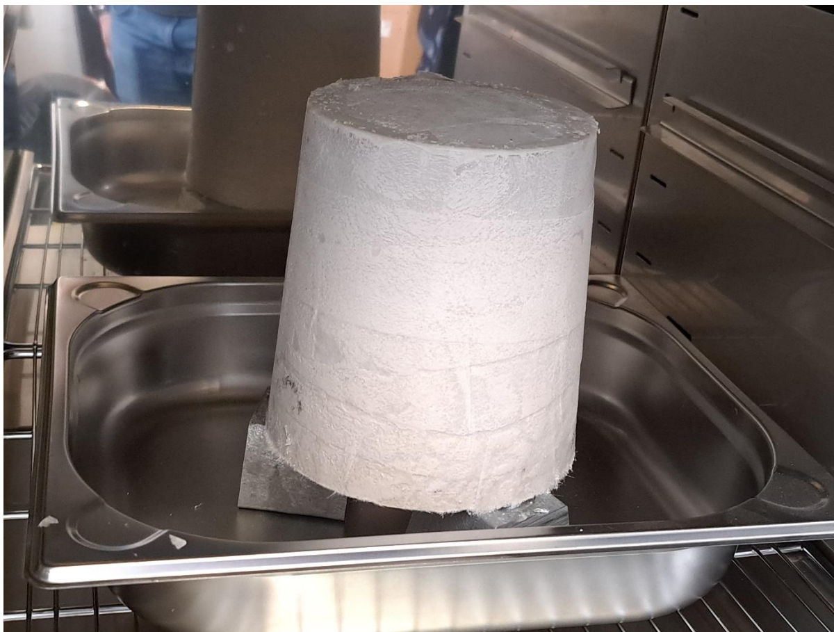
Slika 4.18. Gipsani kalup nakon sušenja
