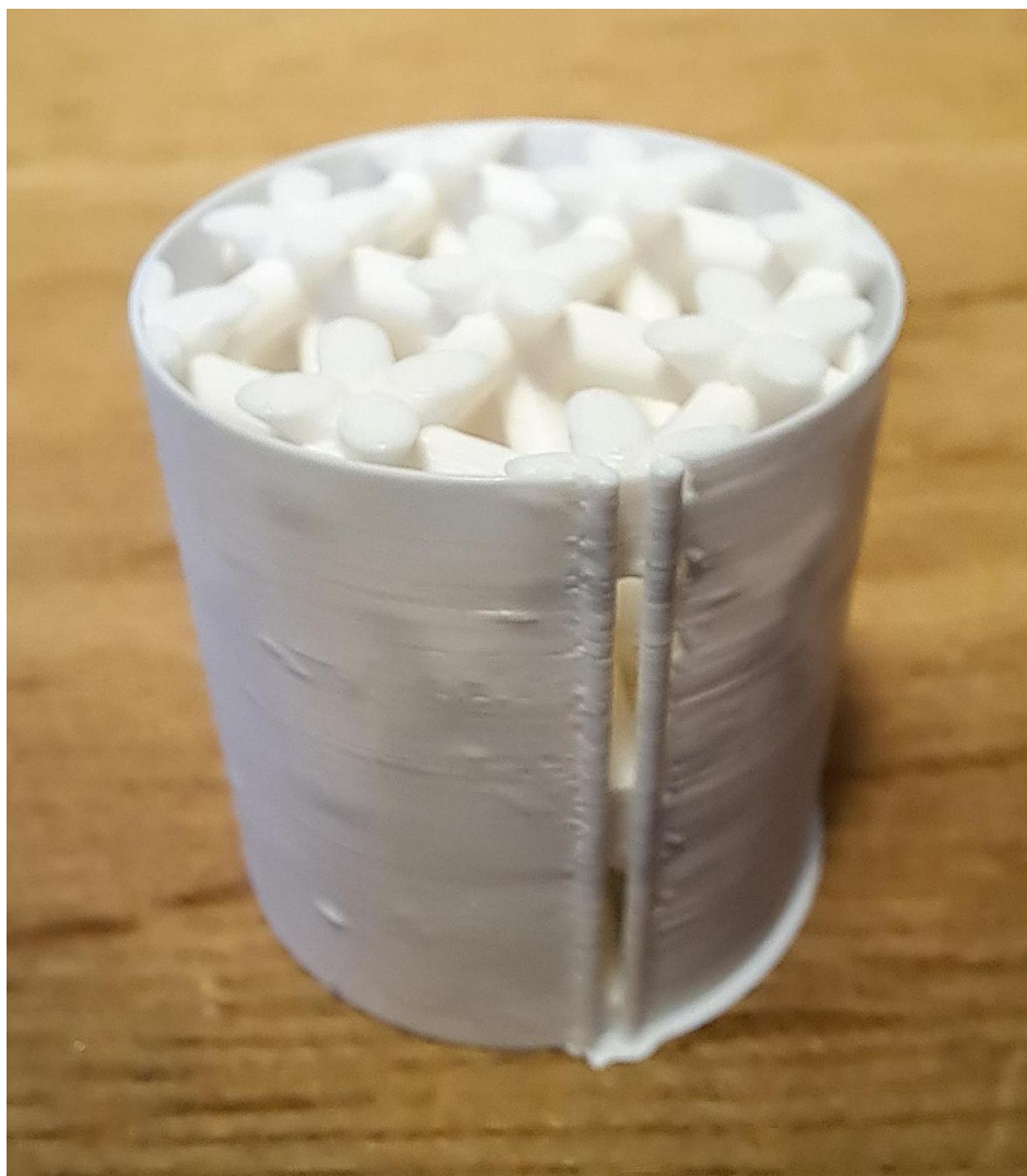
Slika 4.3. Potporna struktura u obliku plašta prije odstranjivanja s ispitnog tijela
