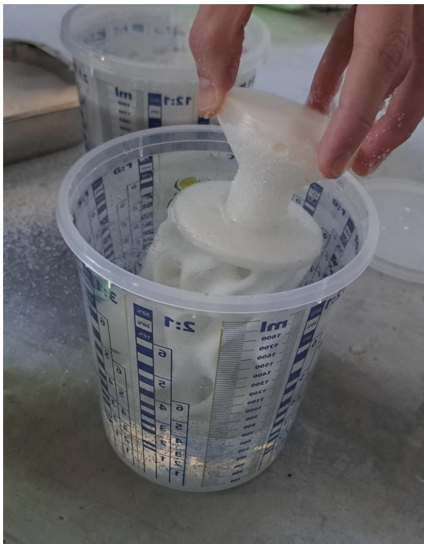
Slika 4.21. Uranjanje pramodela u kloridnu kupku
