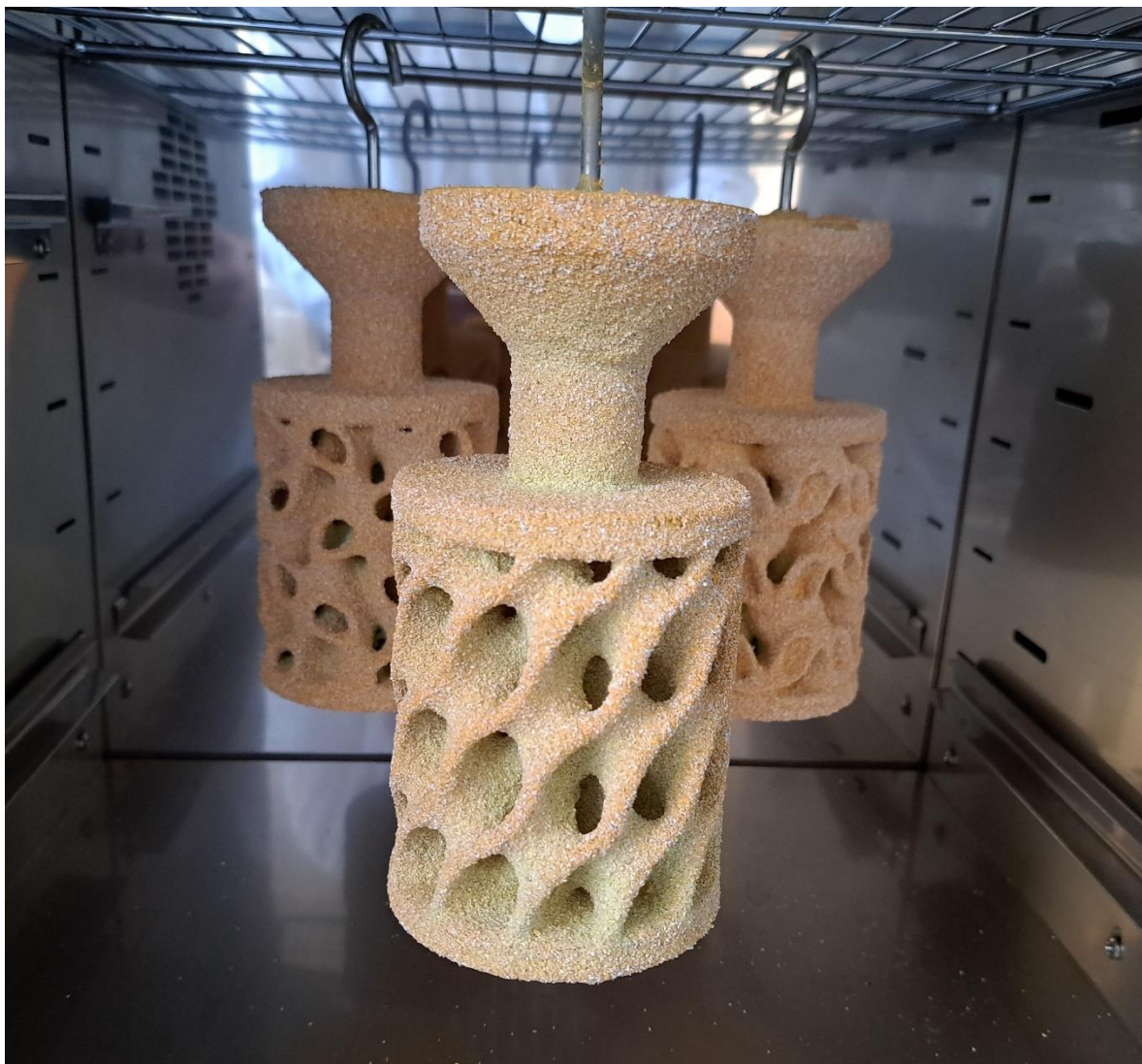
Slika 4.27. Sušenje keramičkih školjki na bazi koloidne silike
