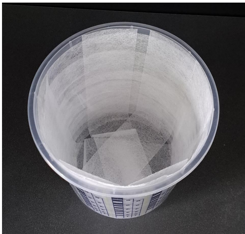
Slika 4.14. Staklena vlakna za ojačavanje gipsanog kalupa
