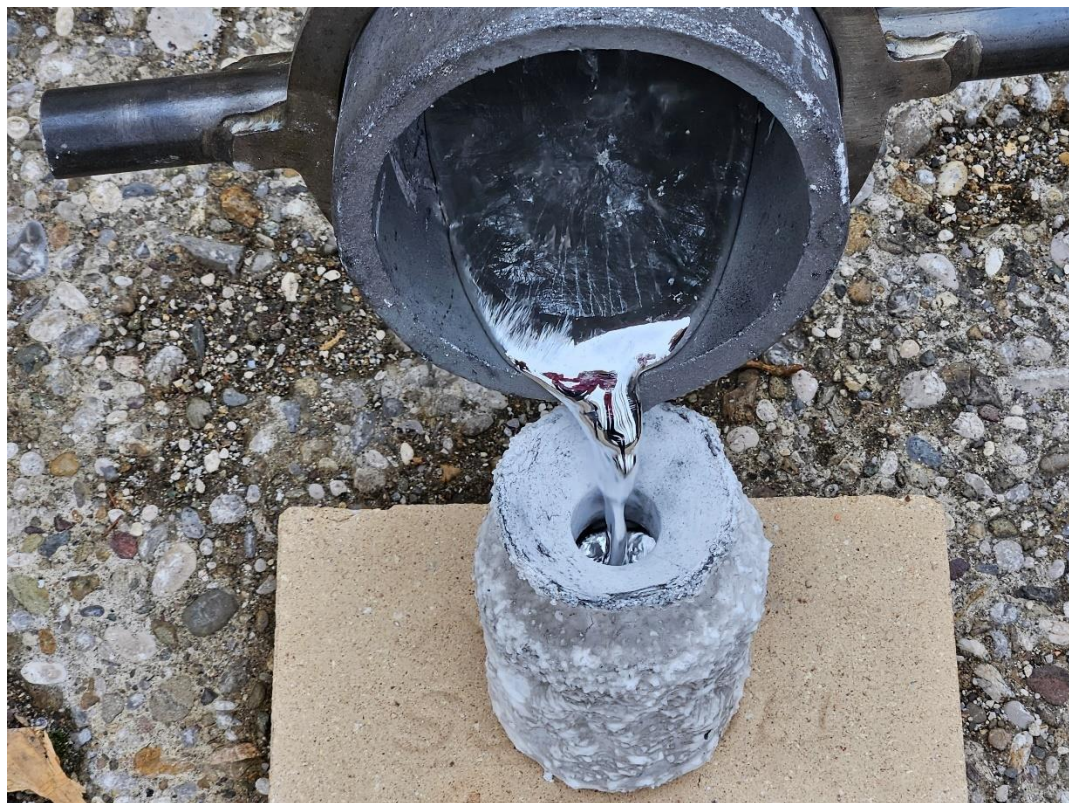
Slika 4.33. Lijevanje legure u keramičku školjku na bazi natrijevog silikata
