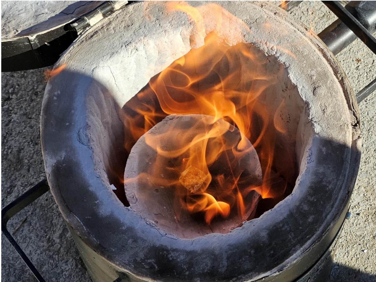
Slika 4.30. Izgaranje pramodela u gipsanom kalupu
