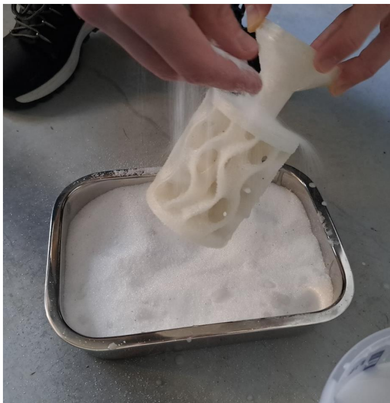
Slika 4.20. Posipavanje pramodela vatrostalnim agregatom
