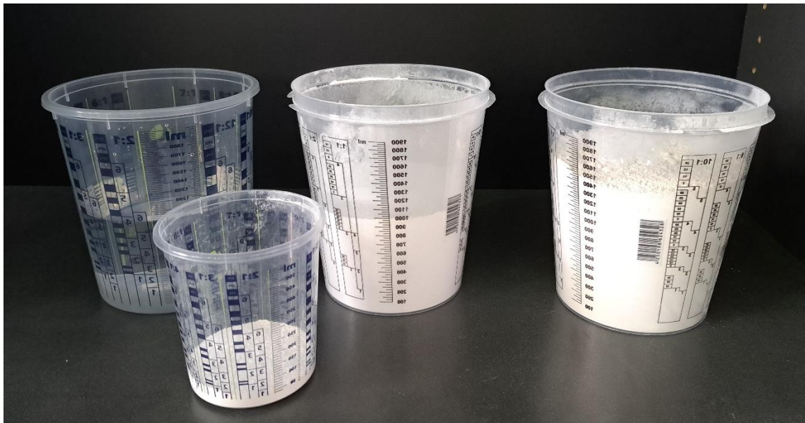
Slika 4.13. Sastojci kalupne mješavine gipsanog kalupa u omjerima
