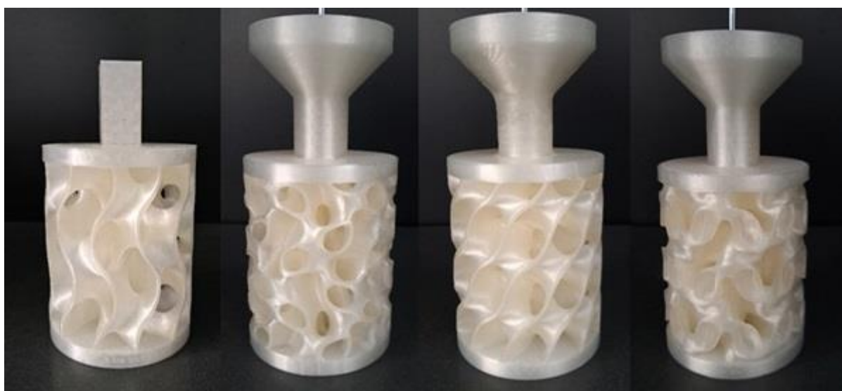
Slika 4.11. Pramodeli izrađeni postupkom FDM u Polycast materijalu
