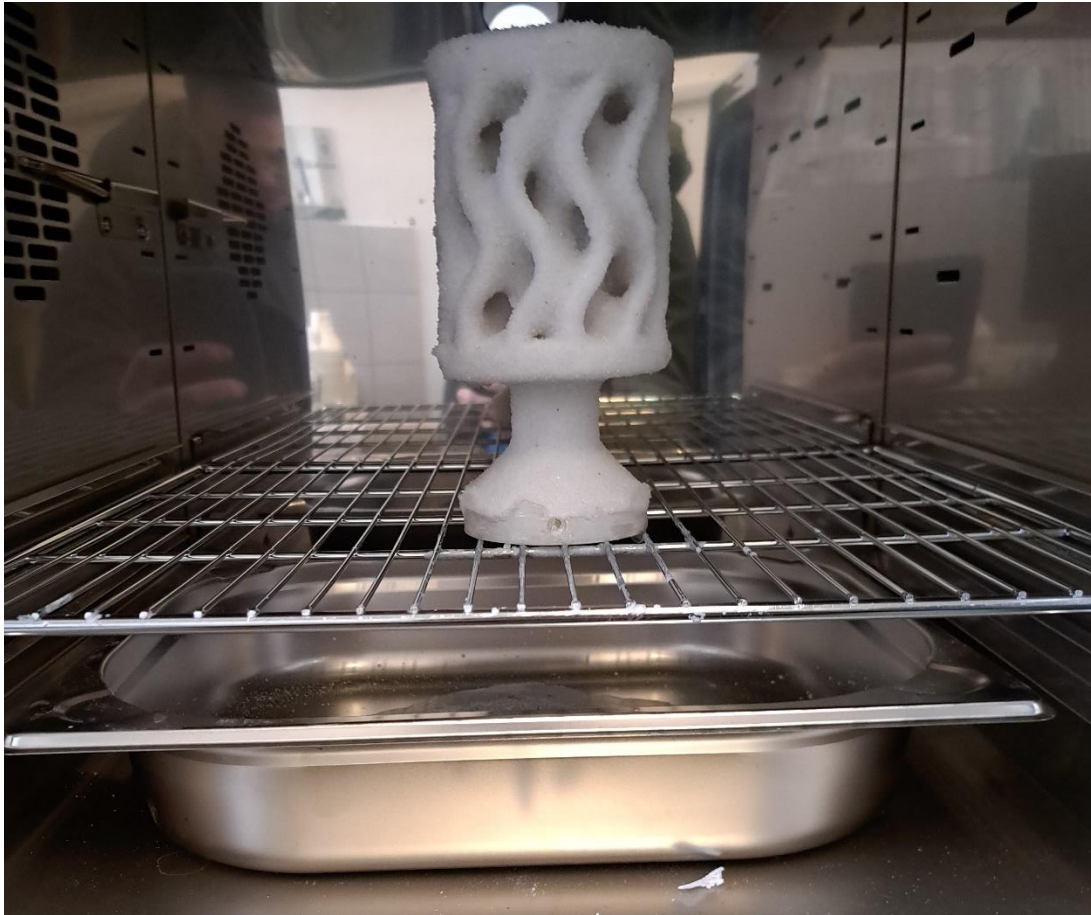
Slika 4.22. Sušenje keramičke školjke u peći
