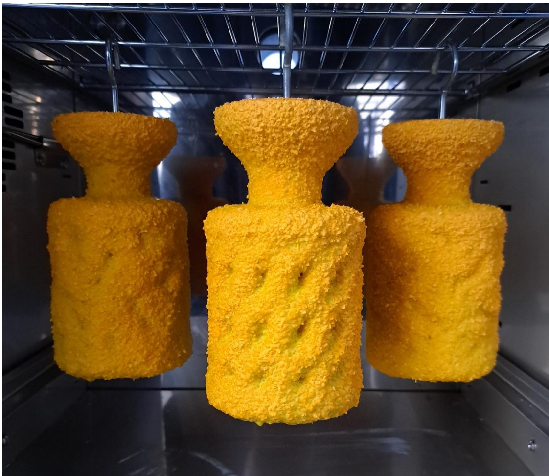
Slika 4.28. Osušene, nežarene keramičke školjke na bazi koloidne silike premazane završnim slojem suspenzije
