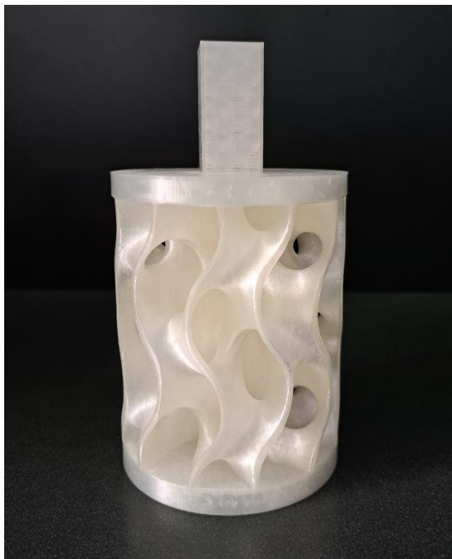
Slika 4.12. Pramodel žiroidne strukture za gipsani kalup
