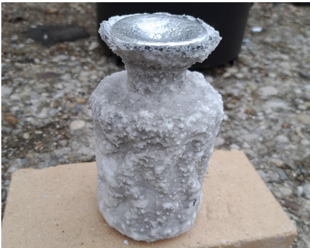
Slika 4.37. Rezultat lijevanja u keramičku školjku na bazi natrijevog silikata
