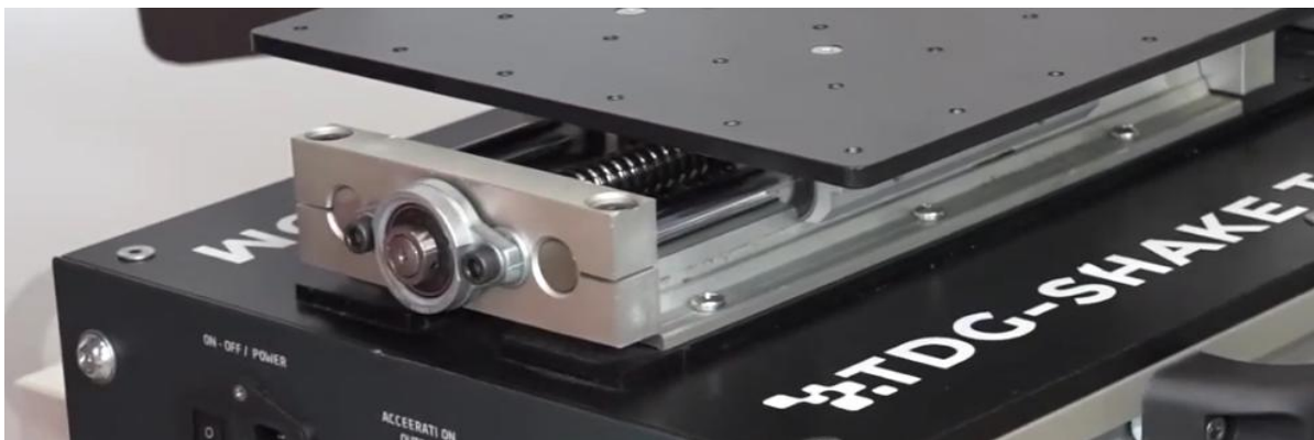
Slika 14. Izvedba pomicanja platforme ATOM, DTG [6.]
