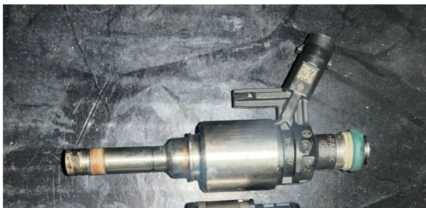
Slika 26. Ubrizgavalica uklonjena iz osobnog vozila
