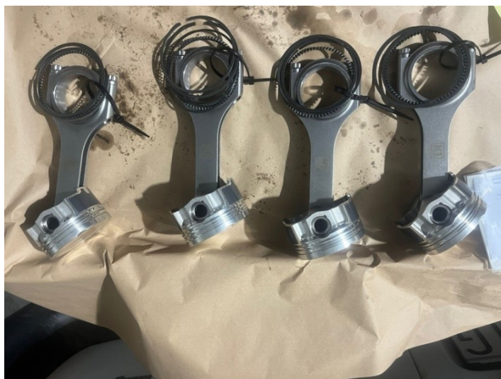
Slika 27. Novi klipovi, klipnjače i prstenovi za potrebe popravka
