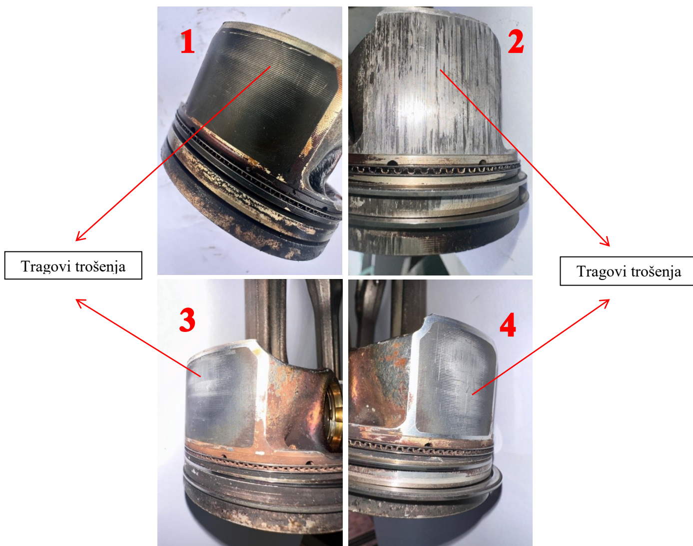
Slika 17. Tragovi trošenja na plaštu klipova 1, 2, 3 i 4
