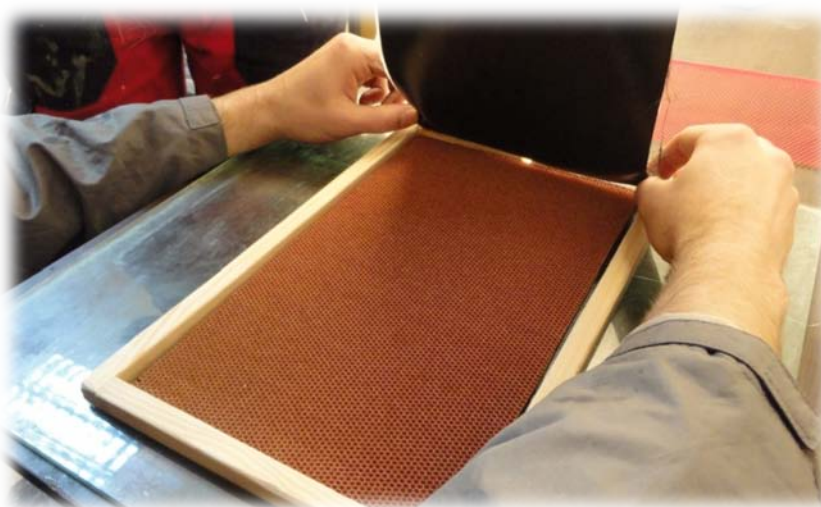
Slika 30. Postavljanje kora na jezgru
