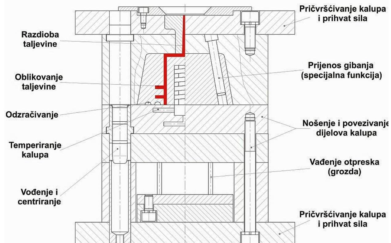
Slika 3.2 Parcijalne funkcije kalupa za injekcijsko prešanje[6]
