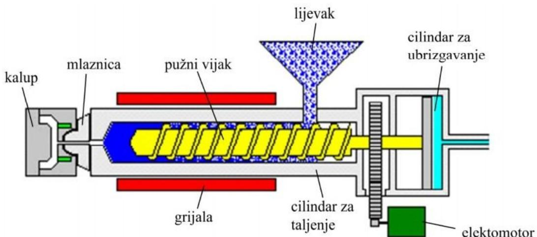
Slika 2.3 Plasticificiranje polimernog materijala[1]
