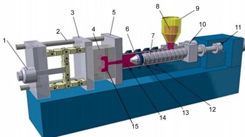
Slika 2.1 Sustav za injekcijsko prešanje[4]: 1 - potisna motka, 2 - priječnica, 3 - pomicni nosač kalupa, 4 - kalup, 5 - nepomicni nosač kalupa, 6 - cilindar za taljenje, 7 - pužni vijak, 9 - plastomer u čvrstom stanju, 10 - lijevak, 11 - jedinica za ubrizgavanje, 12 - grijala, 13 - nepovratni ventil, 14 - taljevina, 15 - otpresak
