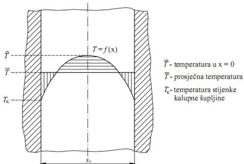
Slika 4.11 Kriteriji određivanja temperature postojanosti oblika otpreska[8]
