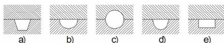
Slika 3.4 Presjeci uljevnih i razdjelnih kanala[6]; a - trapezni, b - polukružni, c - kružni, d - trapezni polukružni sa završetkom, e - pravokutni
