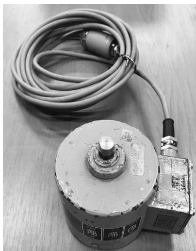
Slika 4.7 Etalonski dinamometar (lims 127/Z30A-50N i lims 108/U1-500N)
