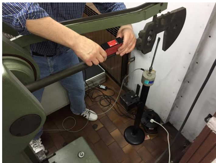
Slika 4.16 Kut klatna pomoću mjeren s klinometrom
