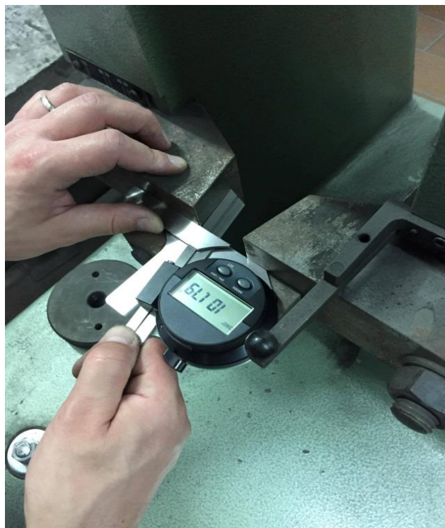
Slika 4.10 Mjerenje kuta podupirača digitalnim kutomjerom
