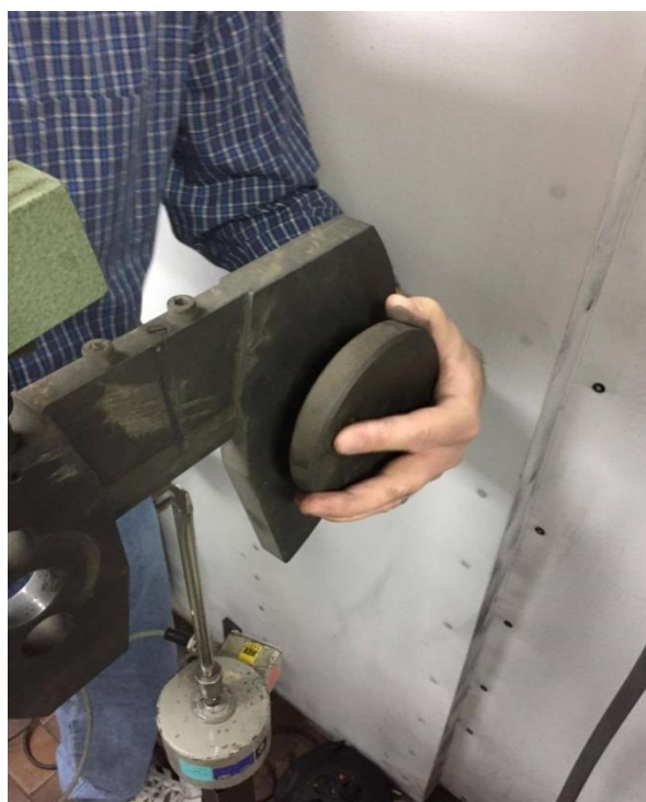
Slika 4.18 Masa bata sa utezima određena s dinamometrom
