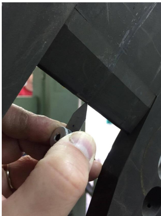
Slika 4.11 Radijus i širina nožnog bata listićima za mjerenje radijusa
