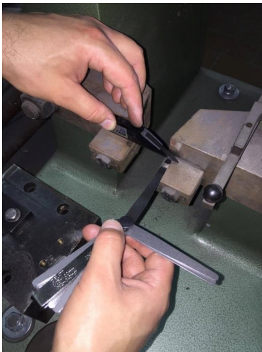
Slika 4.9 Mjerenje visine između podloga pomoću linelana i mjernih listića
