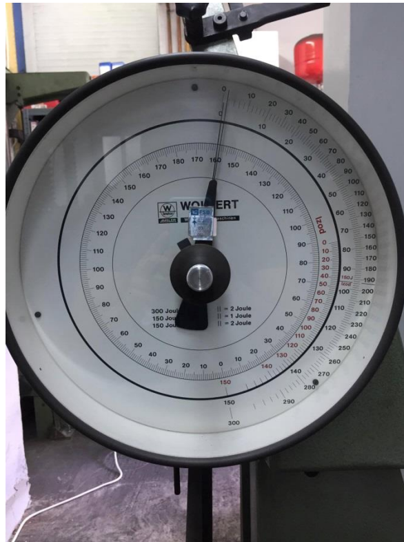
Slika 4.12 Nazivna vrijednost mjerne skale je 150/300 J
