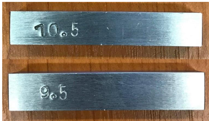
Slika 4.4 Posebno obrađena epruveta 9,5 x 10,5 mm
