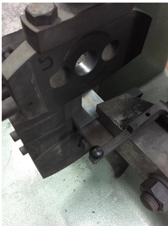
Slika 4.17 Kut klatno epruveta određen pomoću indigo papira
