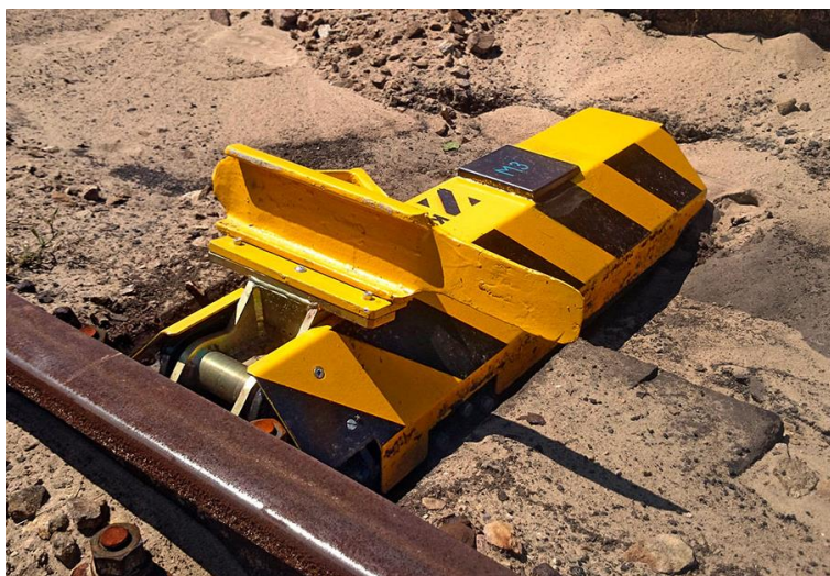
Slika 8.5 Mehanizam blokiranja kotača EMVZ-02
