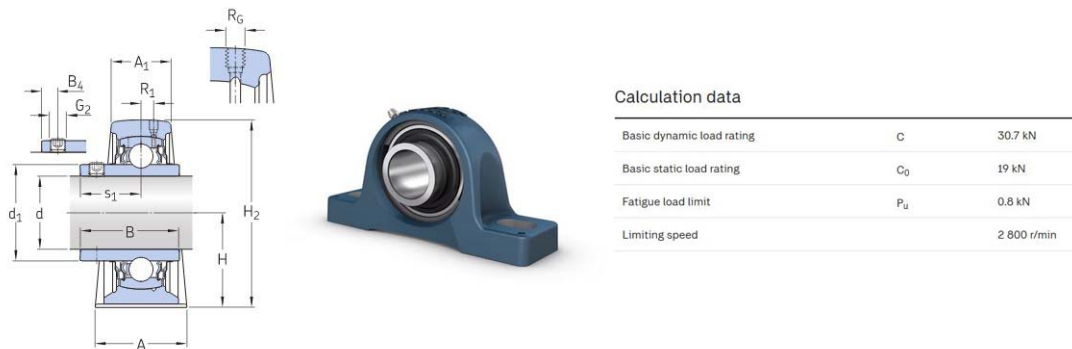
Slika 4.22: Prikaz ležajnog mjesta SY 40 TR (oslonac B) i njegovi tehnički podaci [34]
