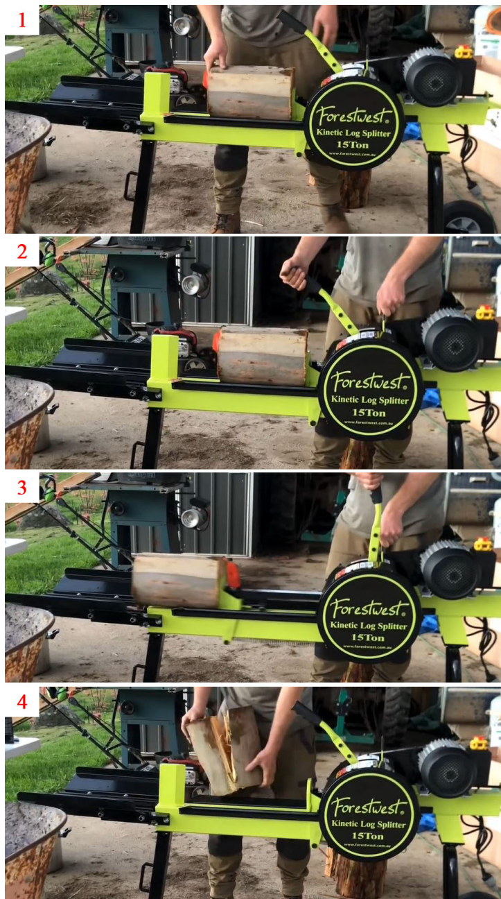
Slika 2.8: Kinetički cjepač - proces [17]
