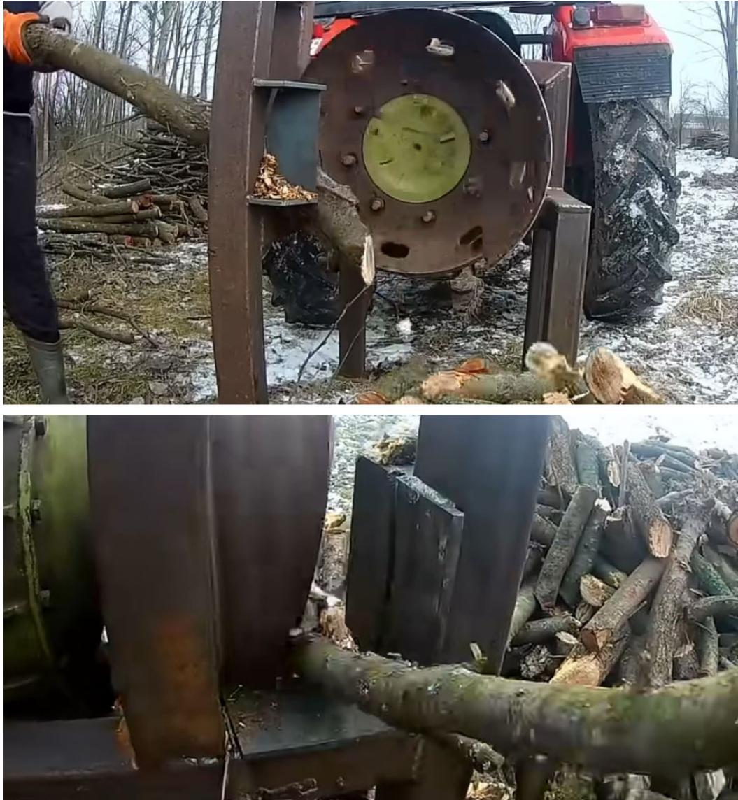
Slika 2.15: Princip rada cjepača s reznim bubnjem [21]
