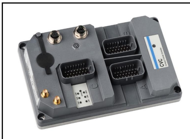
Slika 8. AGV upravljački kontroler kompanije Kollmorgen [24]
