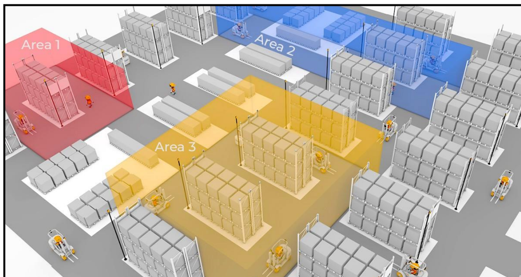
Slika 19. Primjer Geofencing zona unutar skladišta [30]
