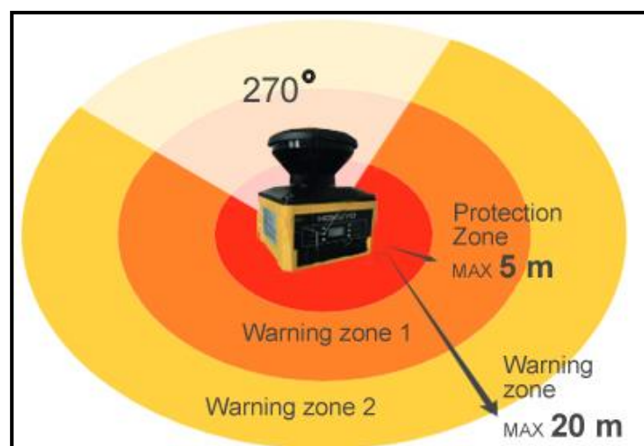
Slika 17. Sigurnosna polja senzora Hokuyo UAM [26]
