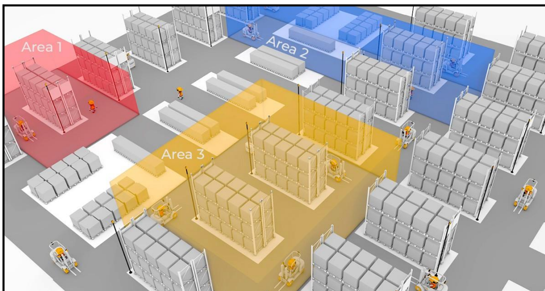
Slika 19. Primjer Geofencing zona unutar skladišta [30]
