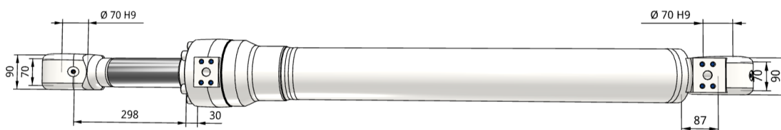
Slika 40 Prikaz cilindra za zakretanje lopate u nacrtu [9]
