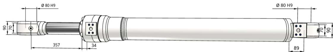
Slika 46 Prikaz cilindra za zakretanje grane bagera u nacrtu [9]
