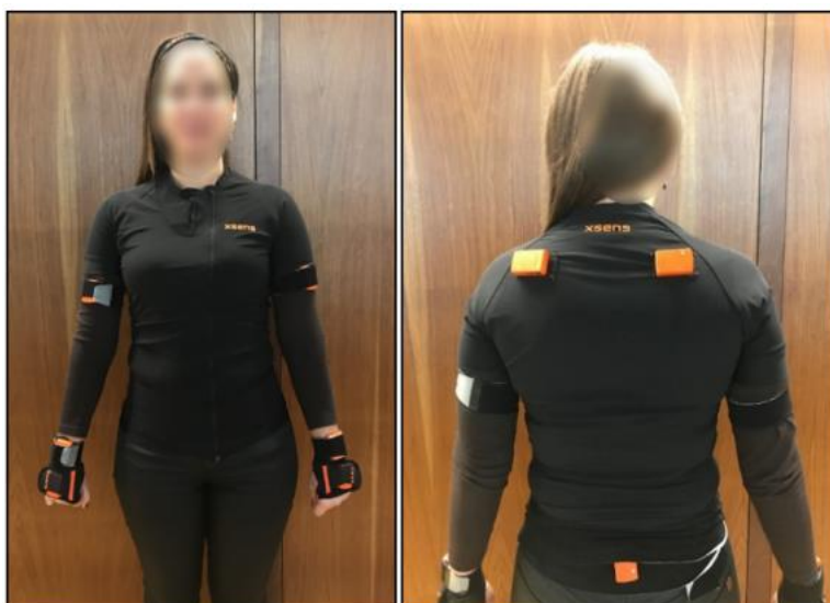
Slika 25. Sudionik s pričvršćenih 11 inercijskih senzora [15]
