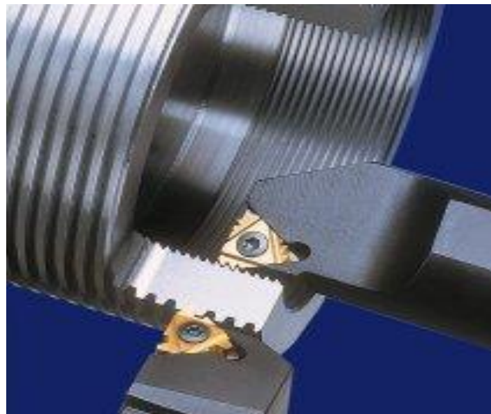
Slika 11. Tokarenje unutarnjeg i vanjskog navoja [7]
