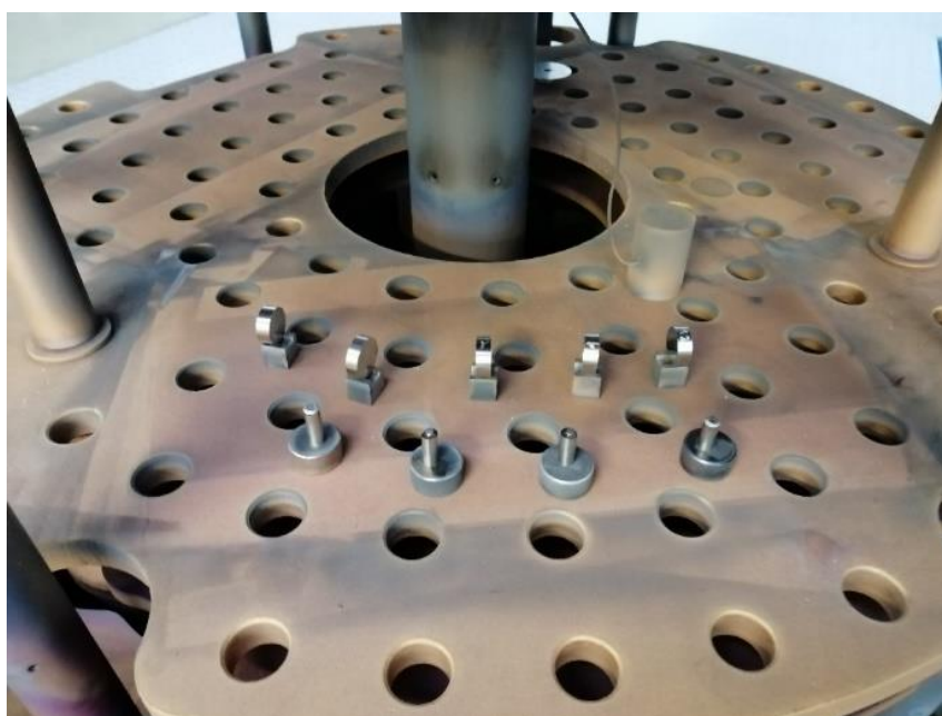
Slika 20. Uzorci legure Ti6Al4V prije PACVD prevlačenja u parnoj fazi
