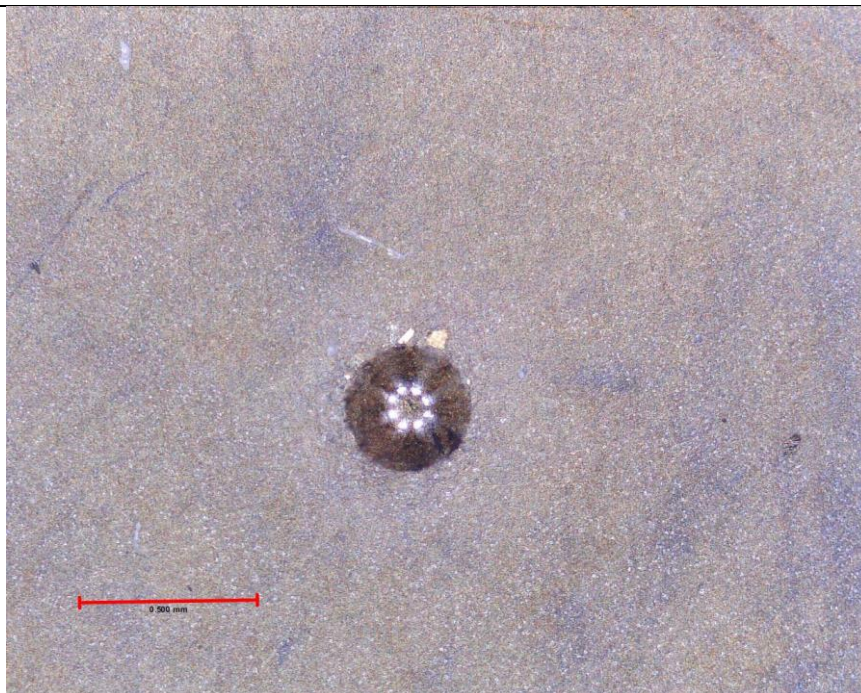
Slika 39. Slika otiska na uzorku D (520 °C/1,5h)
