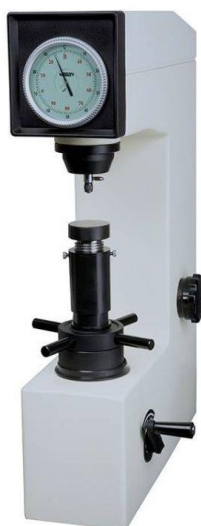
Slika 28. Tvrdomjer Insize za ispitivanje adhezivnosti [26]
