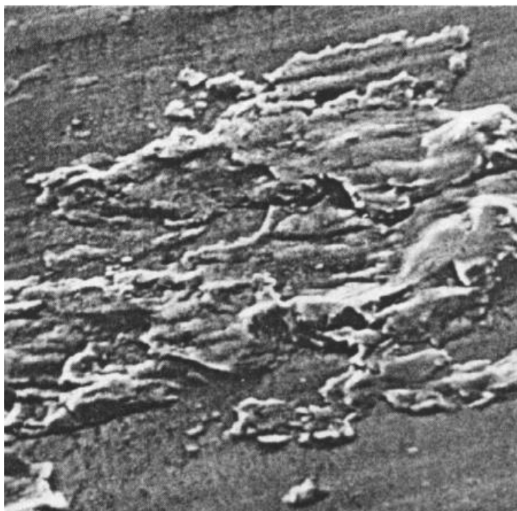
Slika 18. Adhezijom spontano nalijepljene čestice na površinu [11]
