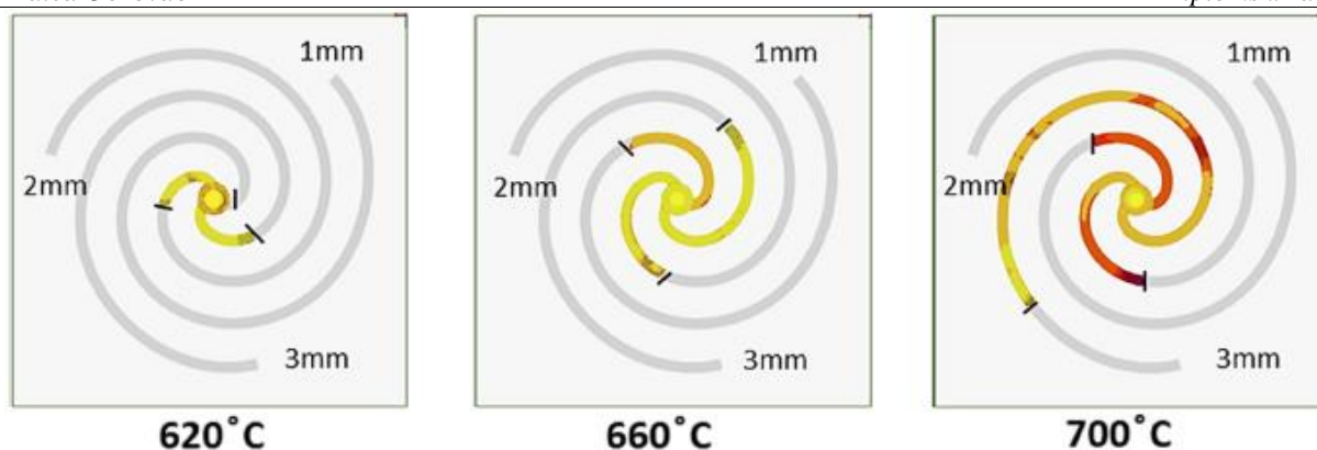
Slika 12. Utjecaj temperature lijevanja na tečljivost [7]
