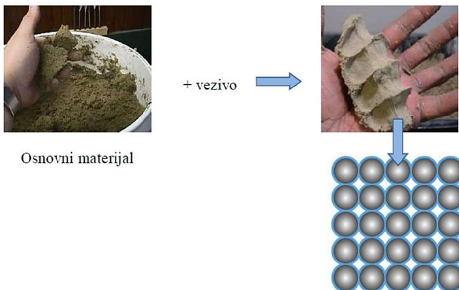
Slika 36. Povezivanje zrnaca pijeska dodatkom veziva [1]
