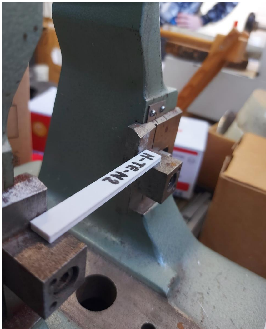
Slika 38. Slika ispitnog tijela (PETG) prije provedenog ispitivanja žilavosti
