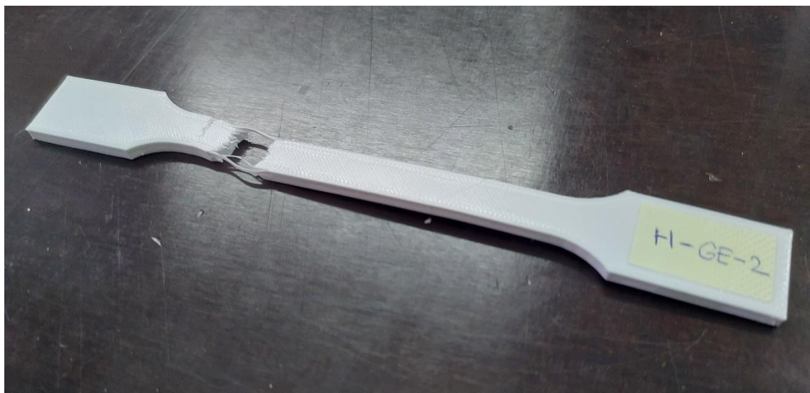
Slika 35. Primjer neispravnog pucanja ispitnog tijela
